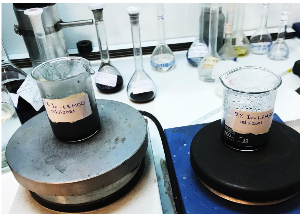
Εικόνα 3.1 Ξήρανση σε θερμαινόμενη πλάκα των καταλυτών Ir/LSMxx κατά τον υγρό εμπότισμό του Ir στους φορείς LSMxx
