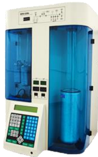
Εικόνα 3.3 Συσκευή Nova 2200e Quantochrome για τον προσδιορισμό των ισόθερμων προσρόφησης-εκρόφησης N_2
