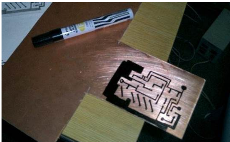
Σχήμα 2.6: Αποτύπωση σχεδίου με τη μέθοδο μαρκαδόρου.
