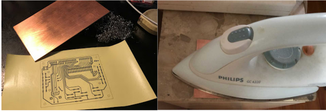
Σχήμα 2.7: Αποτύπωση σχεδίου με τη μέθοδο της θερμομεταφοράς τόνερ.
