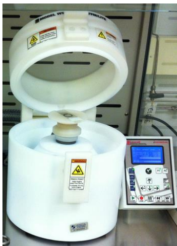
Εικόνα 61: Απεικόνιση ενός spin coater (Hartikainen & Willman, 2019)
