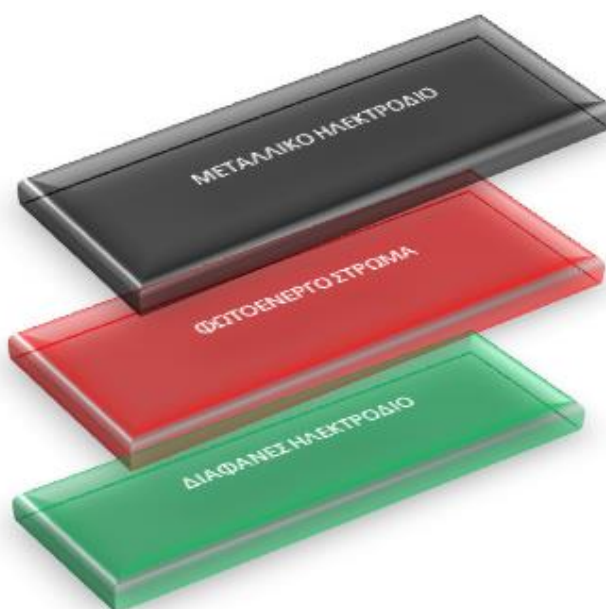
Εικόνα 8: Βασική δομή ενός οργανικού φωτοβολταϊκού κυττάρου
