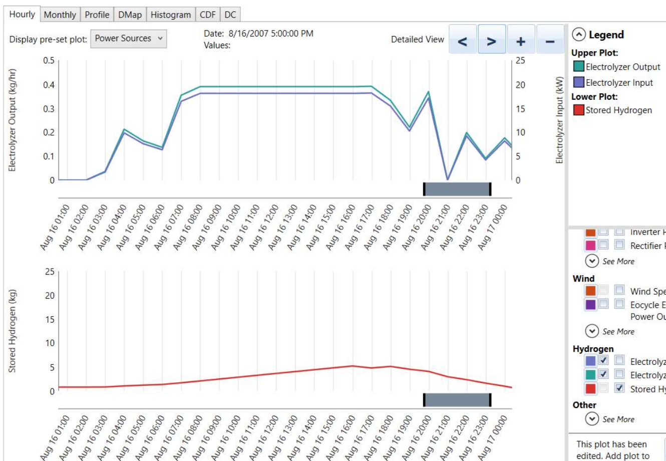
Σχήμα 4.19. Διάγραμμα απόδοσης ηλεκτρολύτη και αποθήκευσης υδρογόνου.
