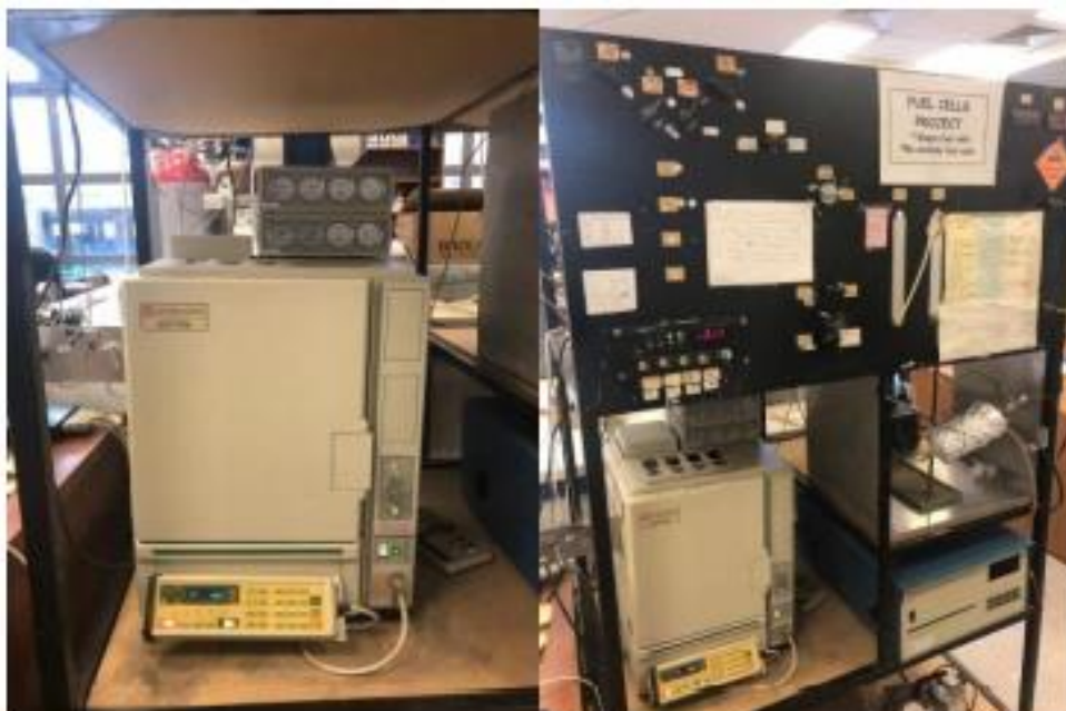
Εικόνα 6.4 Αριστερά: Μονάδα ανάλυσης, Δεξιά: Συνολική πειραματική διάταξη (Τσίντζουρας (2020))
