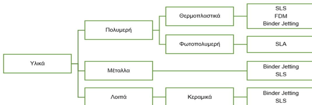
Εικόνα 38. Διάγραμμα ροής επιλογής τεχνολογίας τρισδιάστατης εκτύπωσης βάσει του υλικού
