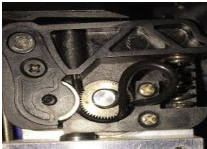
Εικόνα 79. Μπλοκάρισμα του υλικού στον οδηγό του νήματος
