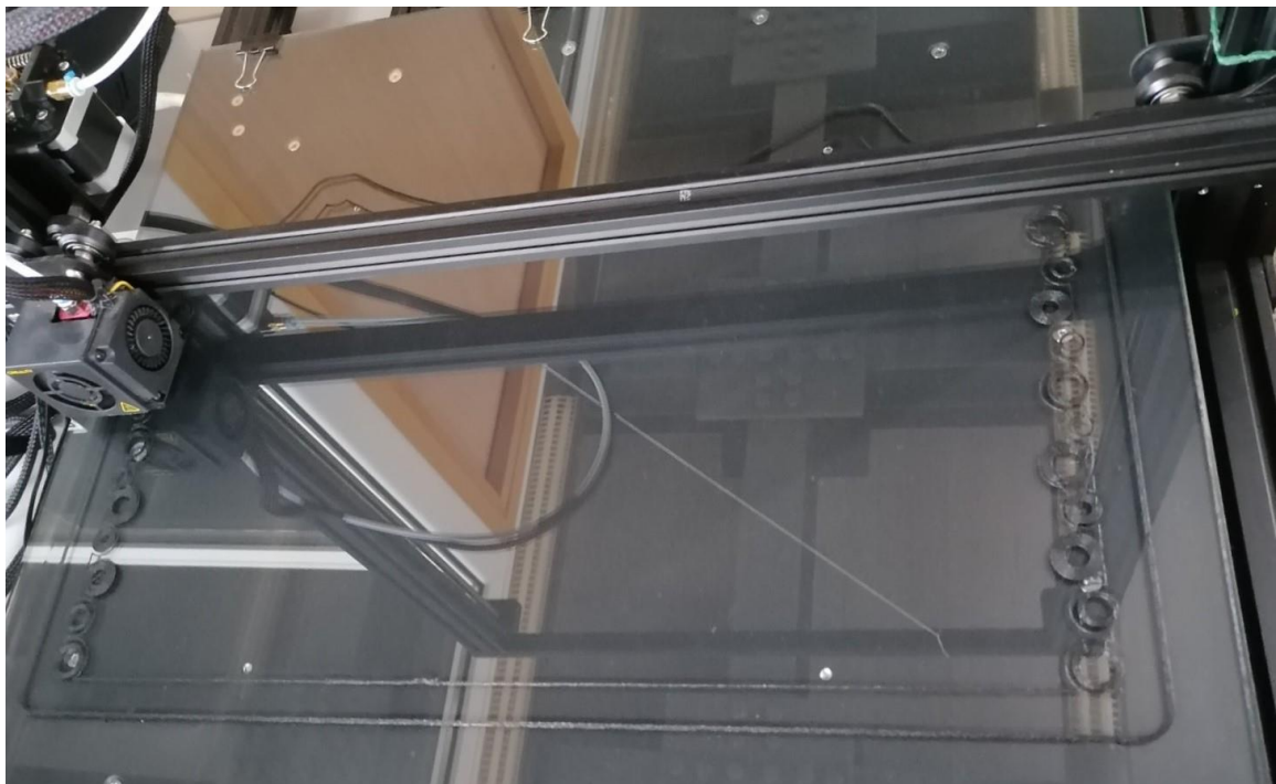
Εικόνα 55. Εκτύπωση της αγκύρωσης (skirt) και του πρώτου στρώματος των τοιχωμάτων
