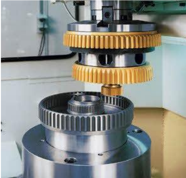
Σχήμα 2.9: Πλάνιση με κύλιση οδοντωτού τροχού
