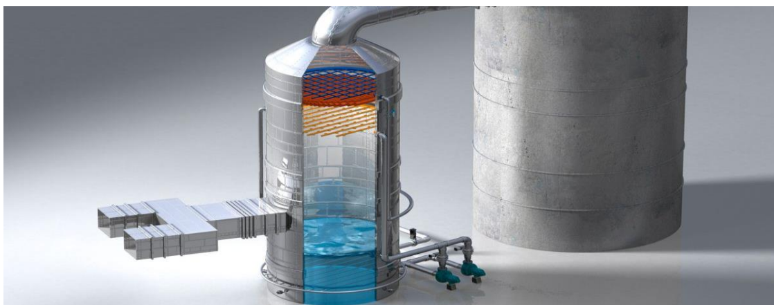
Εικόνα 6.4 Πλυντηρίδα για την απομάκρυνση θειικών ενώσεων (Scrubber).
