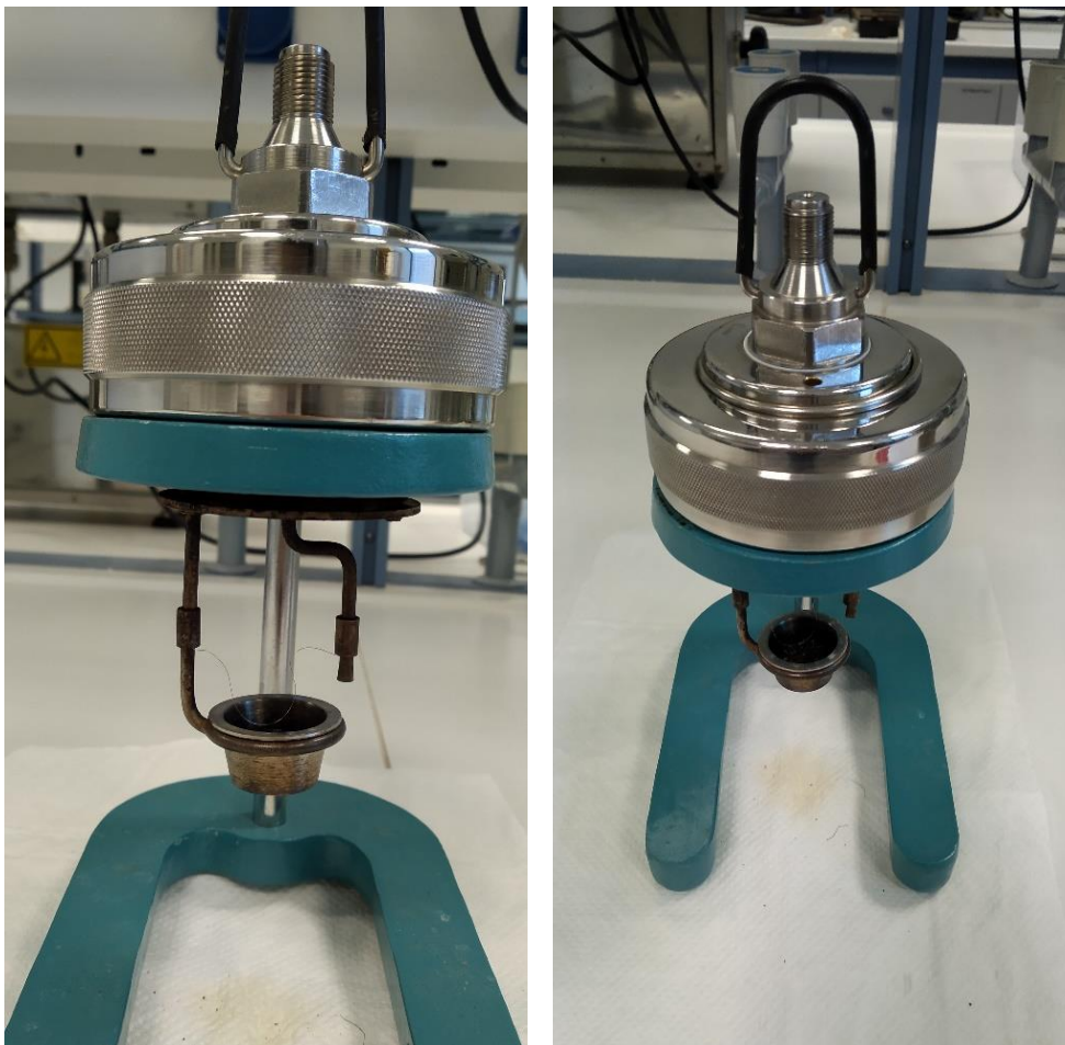
Εικόνα 5.3 Κεφαλή του Oxygen Bomb και οι δυο πόλοι όπου τοποθετείται το σύρμα ανάφλεξης.
