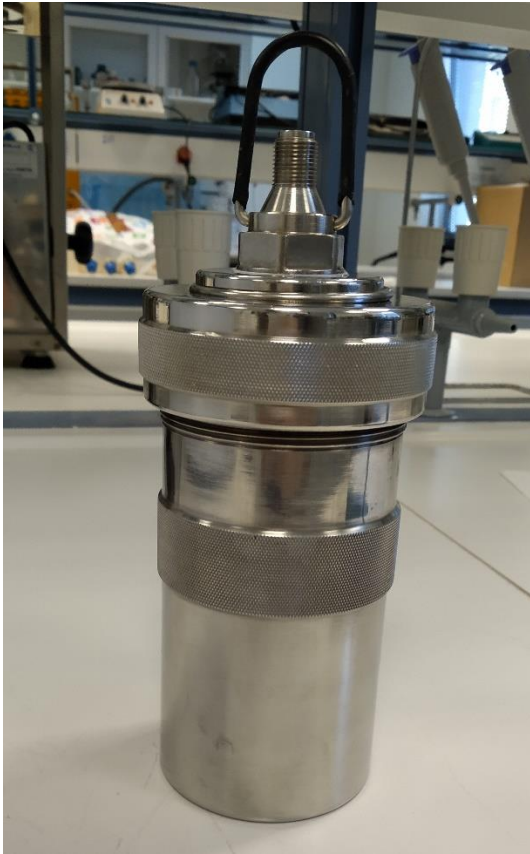
Εικόνα 5.4 Κυλινδρική κεφαλή οξυγόνου όπου έχει τοποθετηθεί το δείγμα και το νερό.
