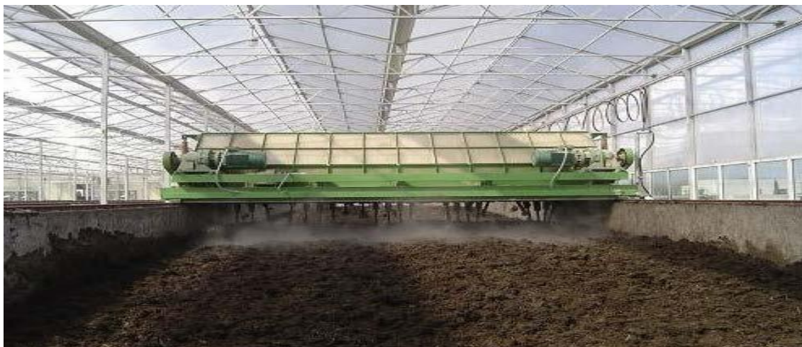
Εικόνα 1.12 Αναμόχλευση κομπόστ σε κλειστό σύστημα.
