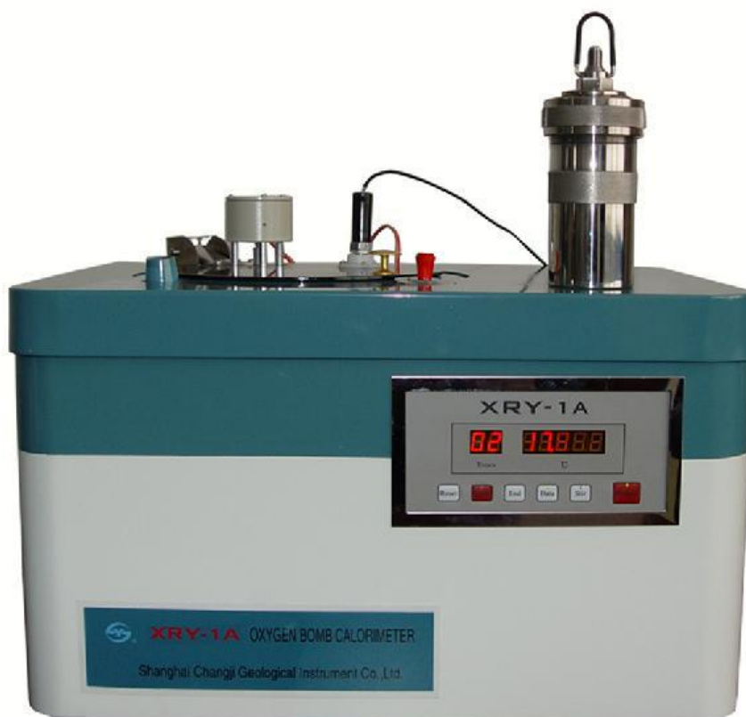
Εικόνα 5.2 Το θερμιδόμετρο XRY-1A (Oxygen Bomb Calorimeter) που χρησιμοποιήθηκε στις μετρήσεις.
