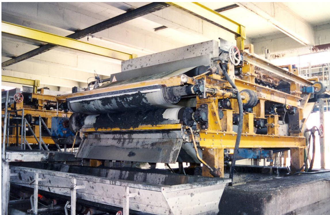
Εικόνα 1.14 Αφυδάτωση ιλύος με ταινιοφιλτρόπρεσα, Ψυττάλεια, Αθήνα. (Πηγή: Σημειώσεις μαθήματος Σχεδιασμός Περιβαλλοντικών Εγκαταστάσεων και Εκτίμηση Περιβαλλοντικών Επιπτώσεων II, Πολυτεχνείο Κρήτης, Τμήμα Μηχανικών Περιβάλλοντος)
