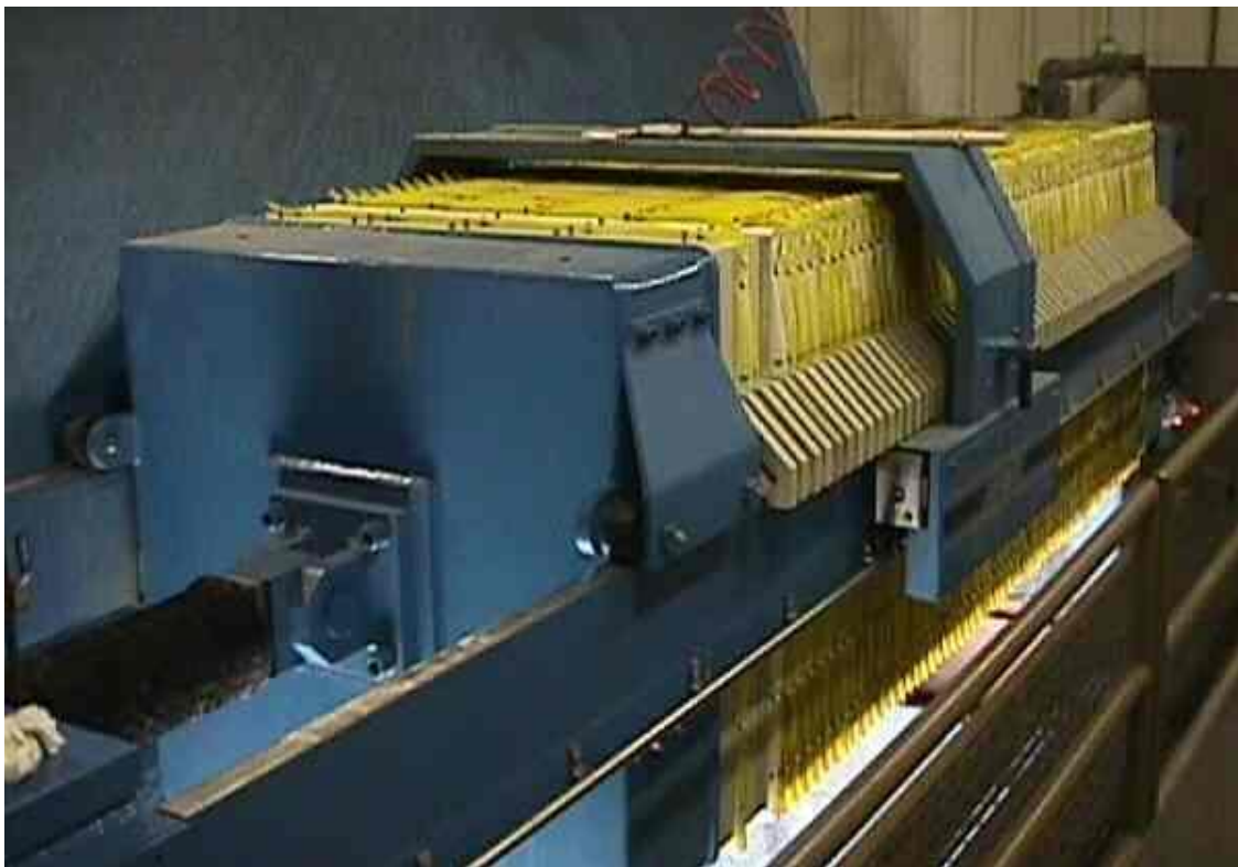
Εικόνα 1.15 Αφυδάτωση ιλύος με θαλαμοφιλτρόπρεσα, Ψυττάλεια, Αθήνα. (Πηγή: Σημειώσεις μαθήματος Σχεδιασμός Περιβαλλοντικών Εγκαταστάσεων και Εκτίμηση Περιβαλλοντικών Επιπτώσεων II, Πολυτεχνείο Κρήτης, Τμήμα Μηχανικών Περιβάλλοντος)
