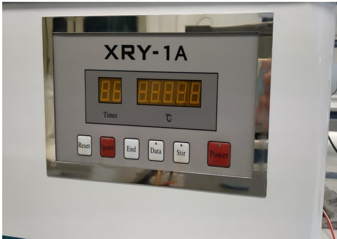
Εικόνα 5.6 Ενδείξεις Stir και Reset για την εκκίνηση της διαδικασίας.
