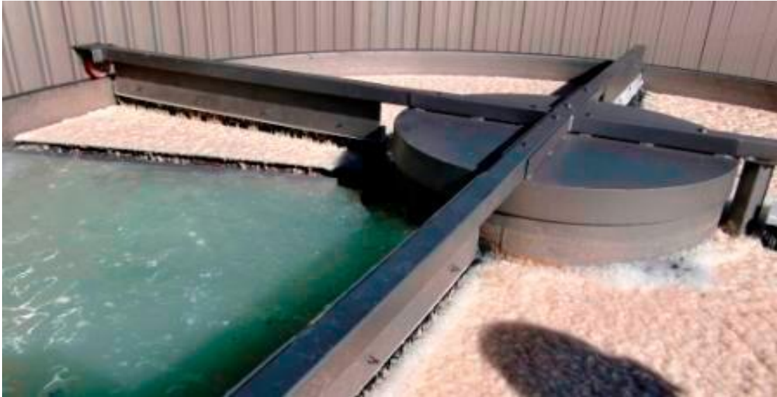
Εικόνα 1.6 Πάχυνση με επίπλευση.
