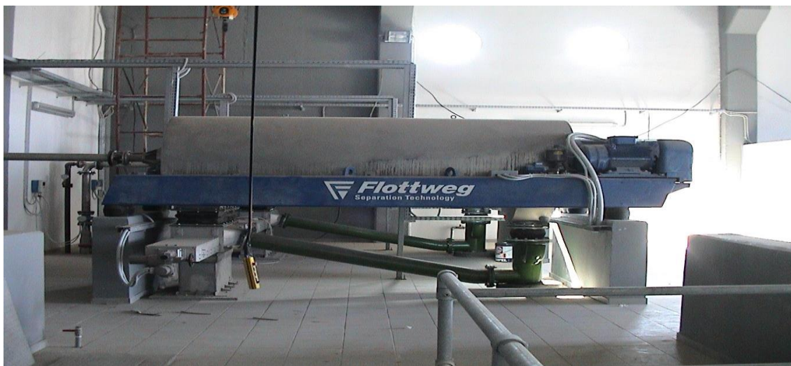
Εικόνα 1.16 Αφυδάτωση ιλύος με φυγοκέντρωση, Ψυττάλεια, Αθήνα. (Πηγή: Σημειώσεις μαθήματος Σχεδιασμός Περιβαλλοντικών Εγκαταστάσεων και Εκτίμηση Περιβαλλοντικών Επιπτώσεων II, Πολυτεχνείο Κρήτης, Τμήμα Μηχανικών Περιβάλλοντος)
