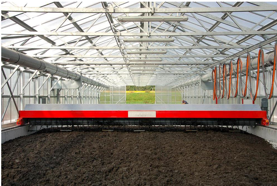
Εικόνα 6.1 Κλειστό σύστημα ηλιακής ξήρανσης.
