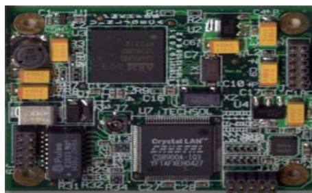
Εικόνα 1.3 Πλακέτα «Ethernet Audio Interface» της Techsol
