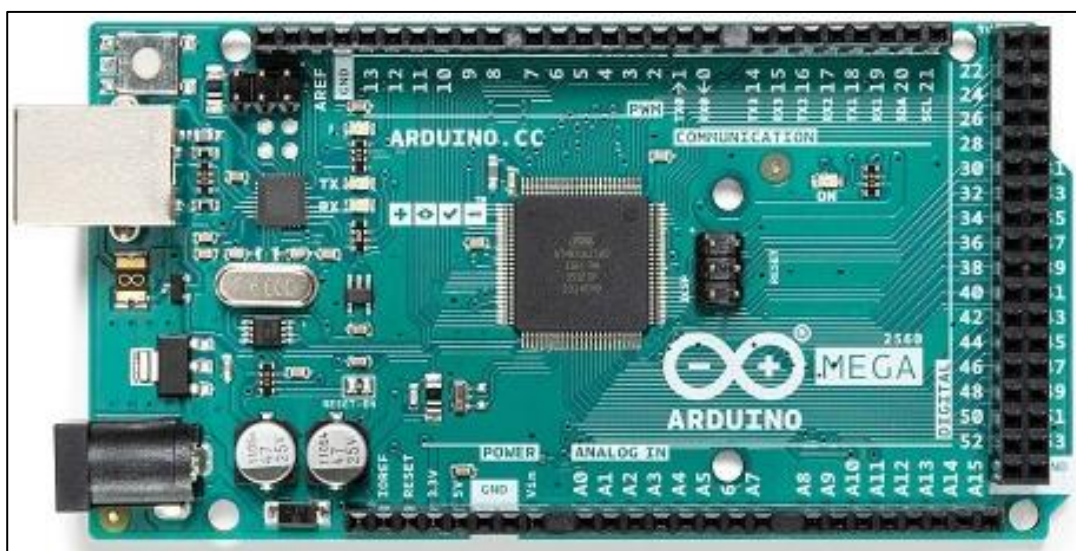
Εικόνα 4.2 Το Arduino Mega 2560 REV3
