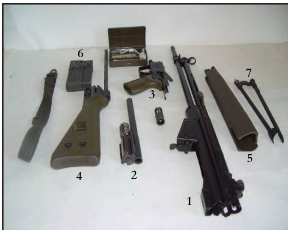
Εικόνα 1.32 Κύρια Μέρη Τυφεκίου G3
