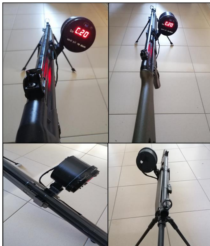
Εικόνα 4.31 Πρότυπο μετρητή πυρομαχικών τυφεκίου G3
