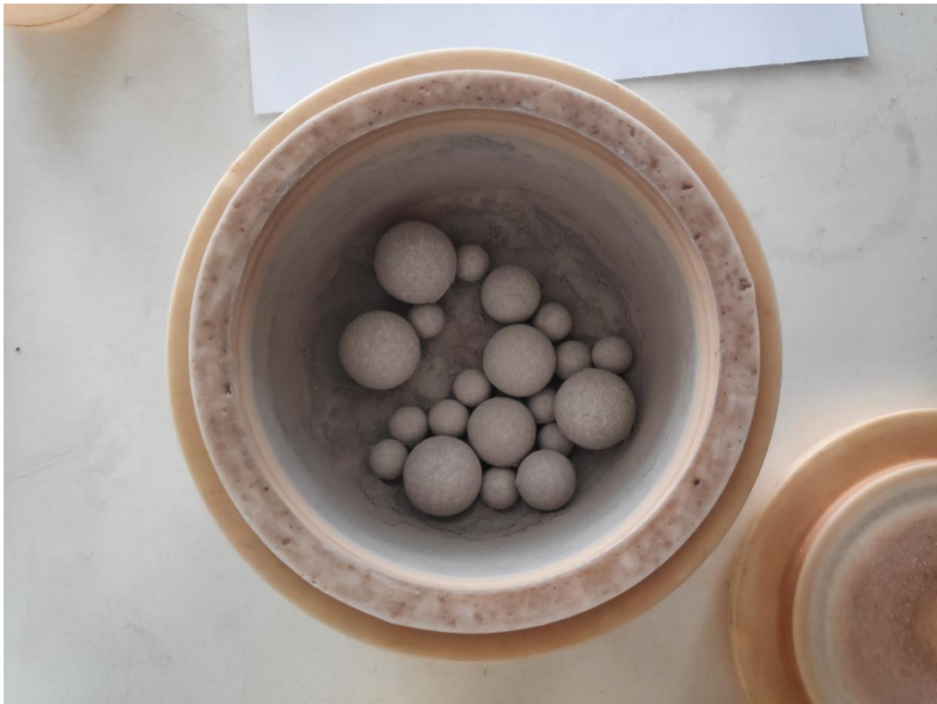
Εικόνα 8.26 Η σκόνη τοποθετημένη εντός του δοχείου με τις μπάλες λειοτριβίσης
