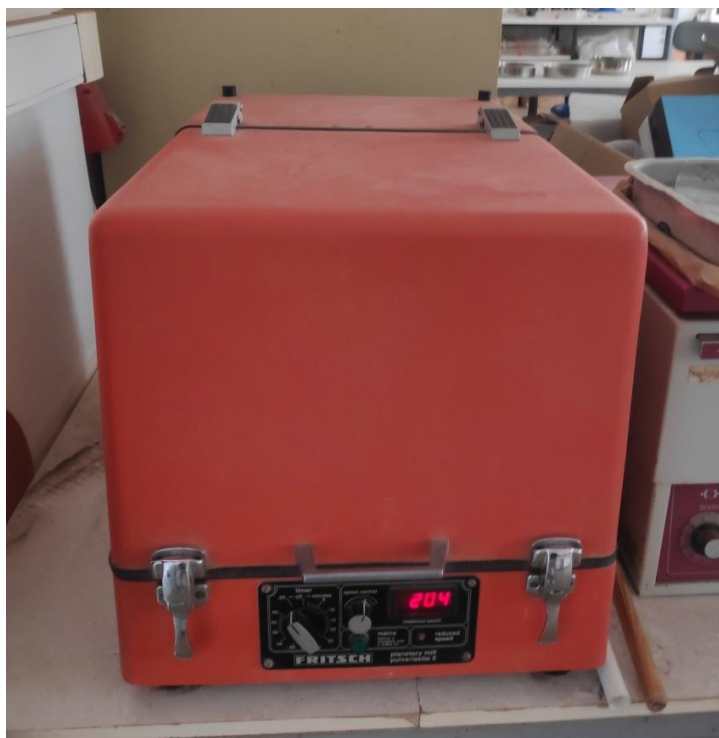
Εικόνα 8.28 Ο μύλος κλειστός εν ώρα λειτουργίας στις 200 στροφές ανά λεπτό.
