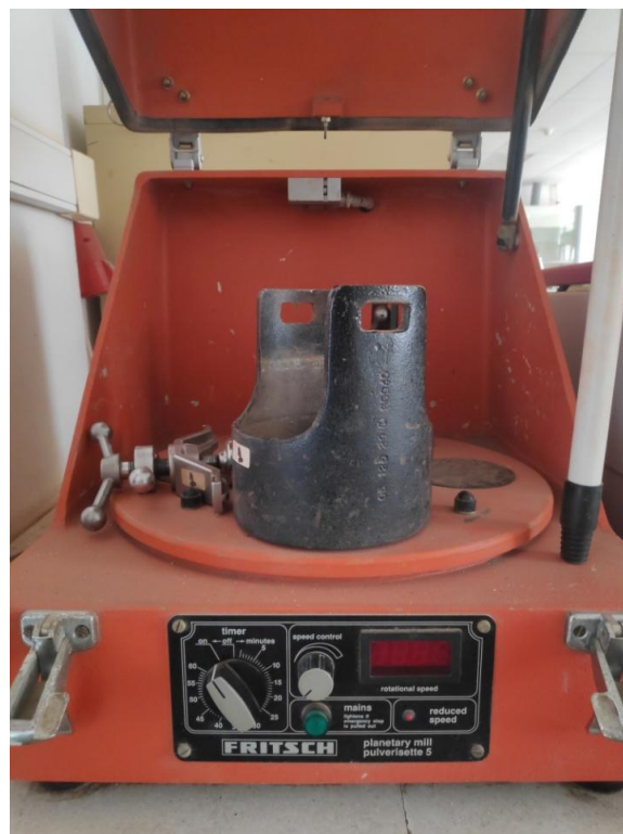
Εικόνα 8.27 Μύλος planetary mill pulverisette 5. Φαίνεται χαρακτηριστικά η μεταλλική θήκη όπου μπαίνει το κεραμικό δοχείο με την σκόνη.
