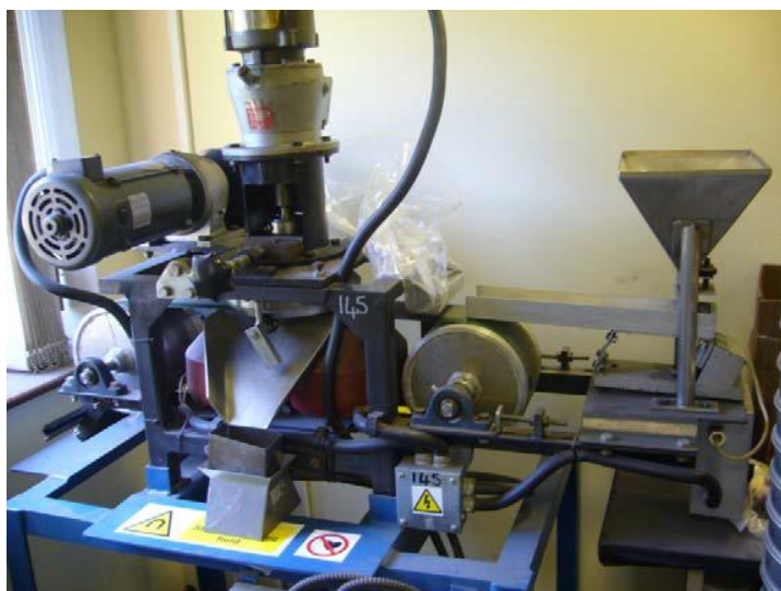
Εικόνα 7.6 Ο διαχωριστής δίσκου στο Master Magnets, Redditch, με σπή τροφοδοσίας ορατή στα δεξιά. Η πράσινη ζώνη που μεταφέρει το υλικό κάτω από τον περιστρεφόμενο δίσκο είναι επίσης ορατή [3].
