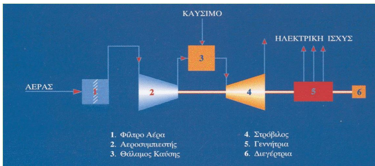
Εικόνα 1.4: Τυπικό διάγραμμα Gas Turbines.
