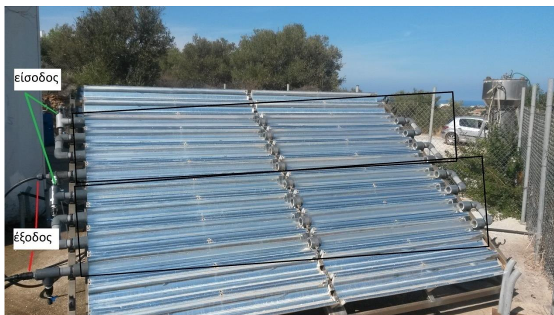
Εικόνα 29. Ο αντιδραστήρας CPC. Φαίνονται οι 2 είσοδοι και έξοδοι και οι 2 ξεχωριστές διατάξεις
