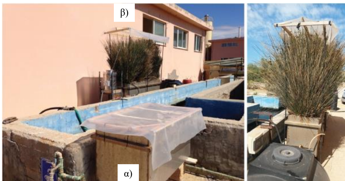
Εικόνα 11. Τεχνητοί υδροβιότοποι Χανίων: α) Υδροβιότοπος χωρίς βλάστηση (Control), β) Υδροβιότοπος με βλάστηση (HSSF).
