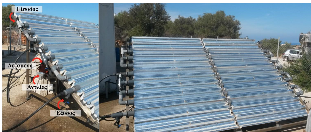
Εικόνα 28. Αντιδραστήρας CPC: διάταξη του πειράματος
