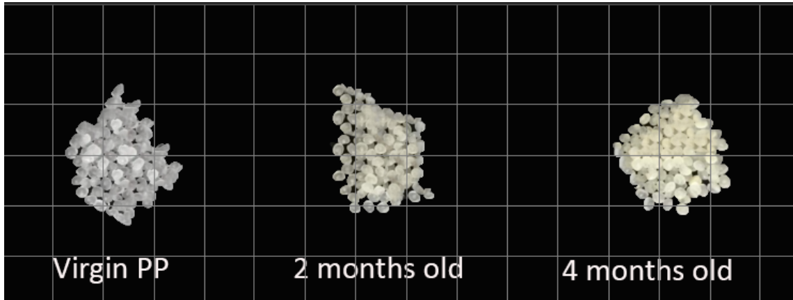
Εικόνα 27 : Αλλαγή χρώματος στα σφαιρίδια πολυπροπυλενίου εξαιτίας της UV-A ακτινοβολίας
