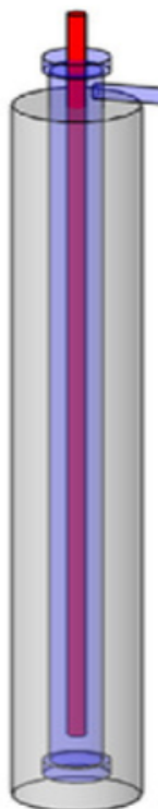
Σχήμα 1.5: Γεωεναλλάκτης ομοαξονικού τύπου [4].
