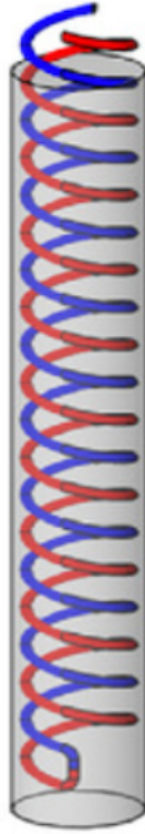
Σχήμα 1.6: Γεωεναλλάκτης τύπου ελικοειδούς [4].
