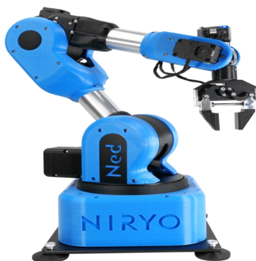
Εικόνα 2.10 Ρομποτικός βραχίονας Niryo One-Ned [19]
