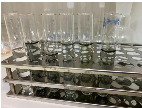
Εικόνα 6: Παραμονή των δειγμάτων στο σκοτάδι για 1 ώρα για την μέθοδο FC
