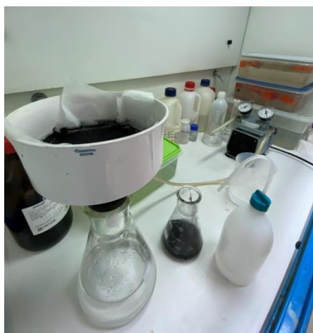
Εικόνα 17: Ρύθμιση pH βιοεξανθρακώματος με χρήση διήθησης
