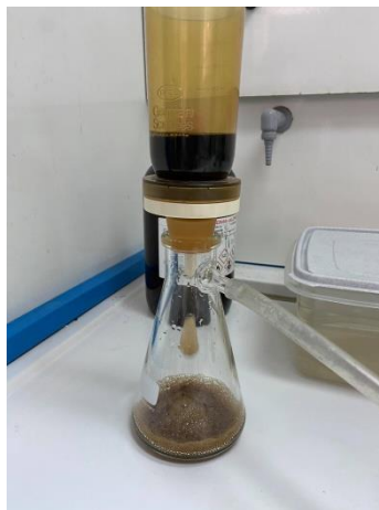
Εικόνα 11: Κατακράτηση στερεών με αντλία κενού για την μέτρηση των TSS
