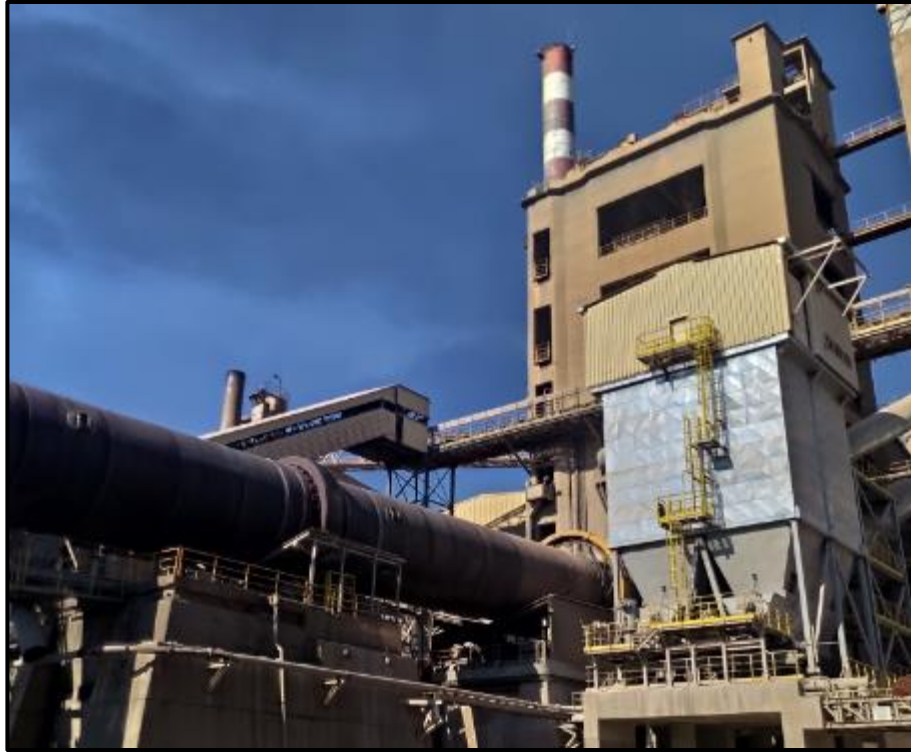
Σχήμα 1.5: Προθερμαντής και περιστροφική κάμινος τσιμεντοβιομηχανίας
