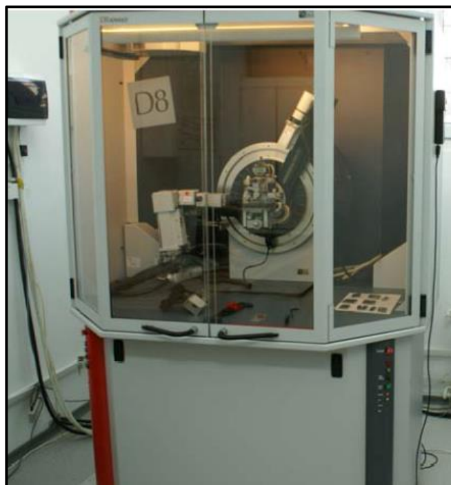
Σχήμα 2.2: Περιθλασίμετρο ακτίνων-X (XRD) τύπου D8-Advance της Brucker AXS
