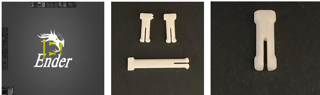
Εικόνα 4.8: Τοποθέτηση Knucle Pin Long, Knucle Pin Short και Thumb Knucle Pin στο bed. Εικόνα 4.9: Τελική εκτύπωση Knucle Pin Short και Knucle Pin Long. Εικόνα 4.10: Τελική εκτύπωση Thumb Knucle Pin
