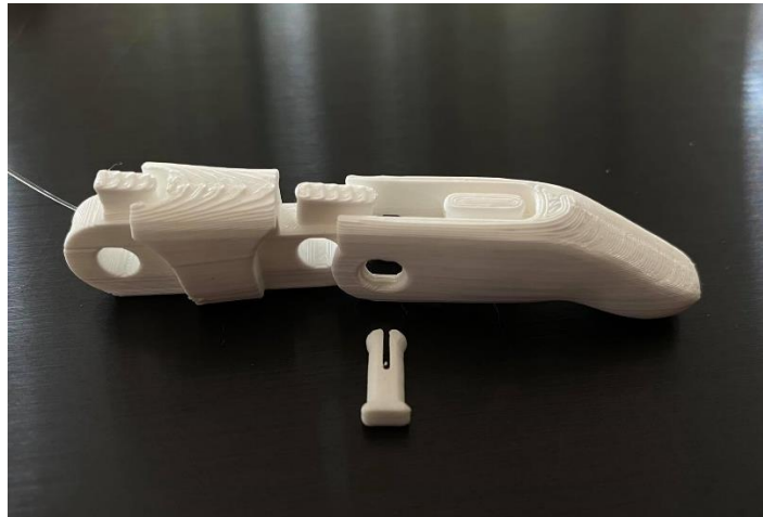
Εικόνα 4.23: Συναρμολόγηση δαχτύλων
