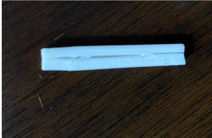
Εικόνα 4.39: Θραύση στα rounded tensioner
