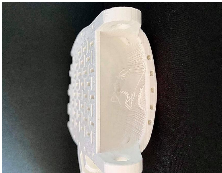
Εικόνα 4.35: Τρέξιμο υλικού στην εσωτερική πλευρά παλάμης
