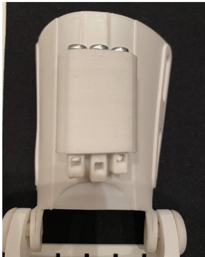
Εικόνα 4.27: Τοποθέτηση tensioner box στο gauntlet
