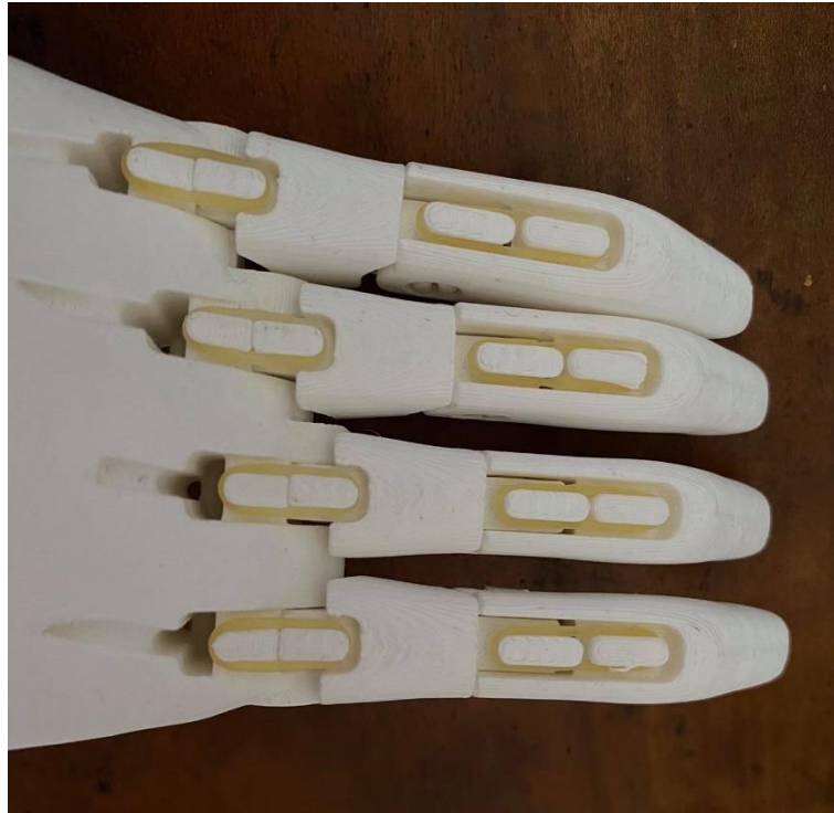
Εικόνα 4.28: Τοποθέτηση λάστιχων στις φάλαγγες των δακτύλων
