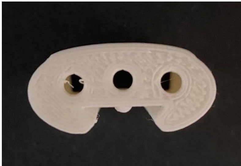
Εικόνα 4.37: Υλικό εγκλωβισμένο στις οπές του tensionner
