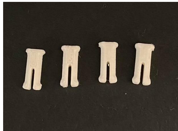
Εικόνα 4.6: Τοποθέτηση Fingertip Pin και Thumbtip Pin στο bed. Εικόνα 4.7: Τελική εκτύπωση Fingertip Pin και Thumbtip Pin αντίστοιχα
