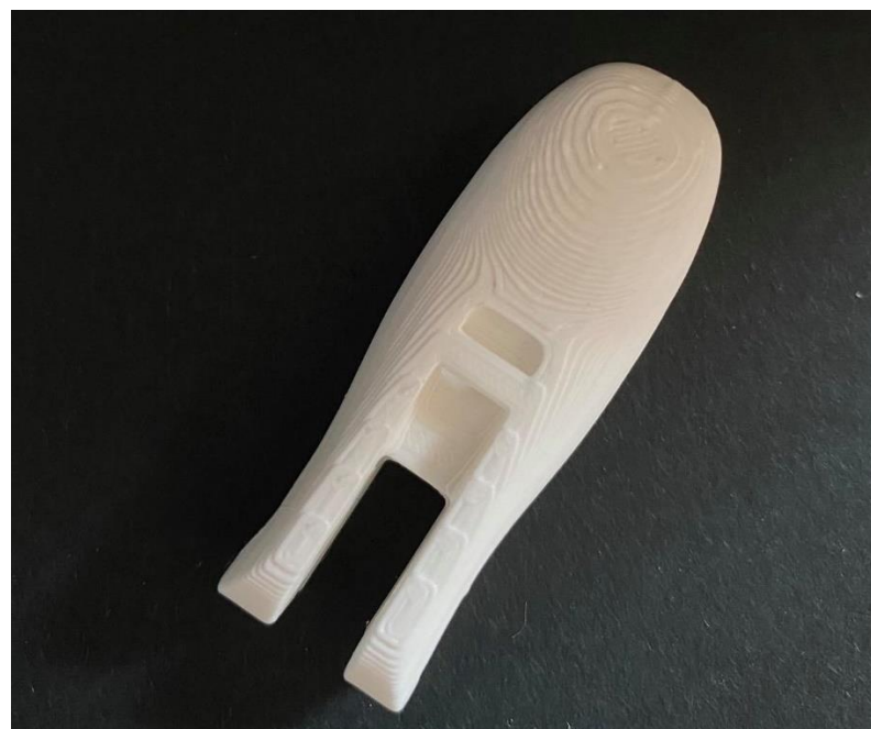
Εικόνα 4.34: Τραχιά επιφάνεια δακτύλου
