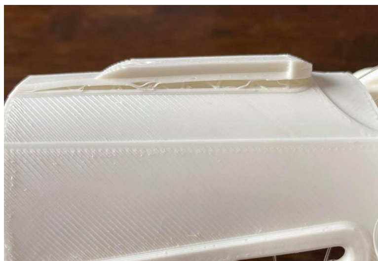
Εικόνα 4.38: Θραύση σημείου κατά την θερμοδιαμόρφωση του gauntlet
