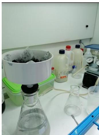
Εικόνα 3.6: Διήθηση ενεργοποιημένου δείγματος με απιονισμένο νερό
