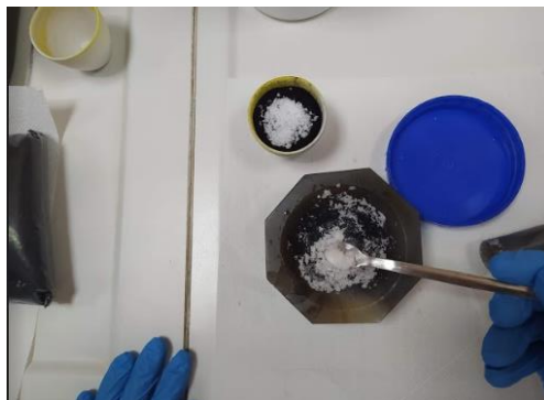
Εικόνα 3.4: Ενεργοποίηση βιο-εξανθρακώματος με καυστικό κάλιο (KOH)
