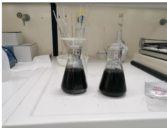
Εικόνα 3.5: Ανάδευση ενεργοποιημένου δείγματος με υδροχλωρικό οξύ (HCl)
