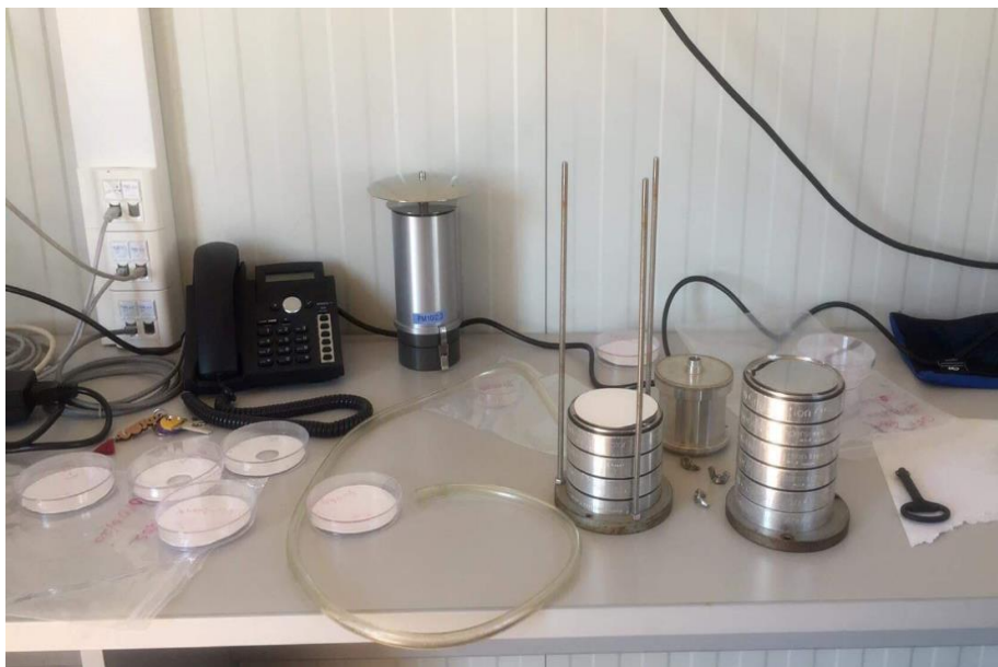
EIKONA 2.4: Προσκρουστήρας διαχωρισμού ANDERSEN C.I. [Εργαστήριο μελέτης ατμοσφαιρικών αιωρούμενων σωματιδίων, Πολυτεχνειούπολη]
