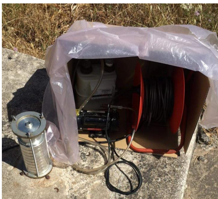
ΕΙΚΟΝΑ 2.12: Τοποθέτηση προσκρουστήρα Andersen σε εξωτερικό περιβάλλον
