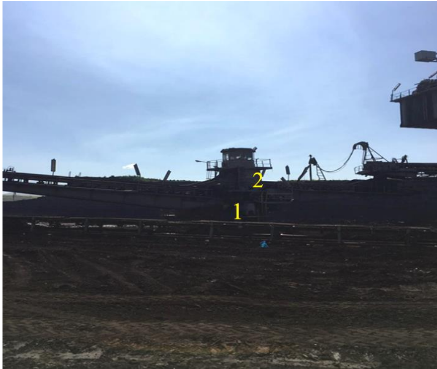
Εικόνα 17 : Ταινιόχημα σε ώρα λειτουργίας του Λιγνιτικού Κέντρου Μεγαλόπολης, στο πεδίο Δυτικό Χωρέμι, όπου απεικονίζεται 1. η κατωδομή και 2. η ανωδομή.
