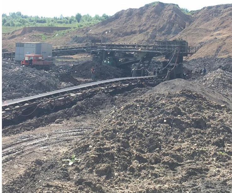
Εικόνα 10: Εργασίες για την μετάθεση του ταινιοδρόμου του Λιγνιτικού Κέντρου Μεγαλόπολης στην περιοχή του Δυτικού Χωρεμίου.
