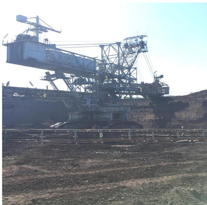
Εικόνα 15 : Καδοφόρος εκσκαφέας εν ώρα λειτουργίας στο πεδίο Δυτικό Χωρέμι του Λ.Κ.Μ. όπου διακρίνεται η κατωδομή, το σύστημα πορείας, η ανωδομή και 1. ο βραχίονας του καδοτροχού 2. ο καδοτροχός 3. ο πύργος 4. ο βραχίονας απόρριψης. 5. και παράλληλα από τον καδοφόρο εκσκαφέα φαίνεται η μεταφορική ταινία.
