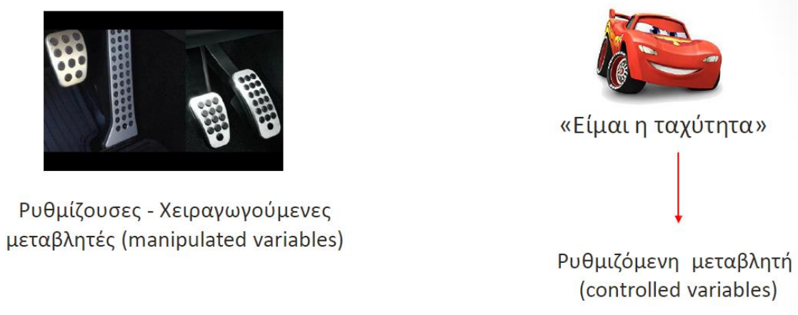
Σχήμα 1.8: «Οι μεταβλητές στο Σύστημα Ελέγχου της ταχύτητας σε ένα όχημα» [9]
