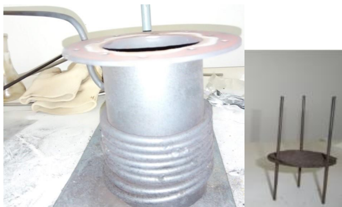
Εικόνα 3.2 Κυλινδρικός αντιδραστήρας ανοξείδωτου χάλυβα και πυράντοχη σίτα
