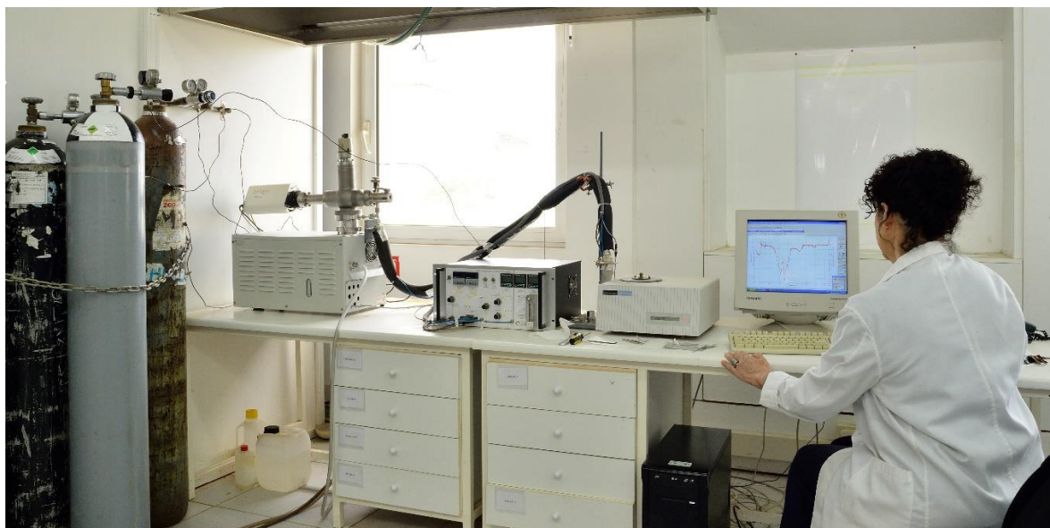
Εικόνα 3.5 Διάταξη θερμοζυγού-φασματογράφου μάζας (TG-MS)
