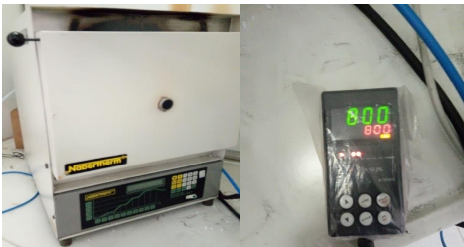
Εικόνα 3.3 Φούρνος 'Nabertherm' και ο ρυθμιστής θερμοκρασίας του
