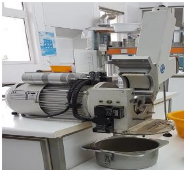
Εικόνα 3.1 Μαχαιρόμυλος τύπου Pulverisette 15
