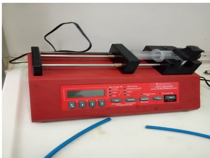
Εικόνα 3.4 Αντλία παροχής νερού [σύριγγα που περιέχει απιονισμένο νερό + σωληνάκια σύνδεσης]
