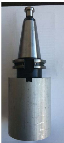
Σχήμα 3.12 Τοποθέτηση του δοκιμίου στον κώνο Wellington
