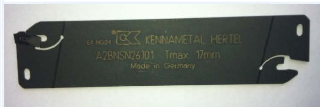
Σχήμα 3.13 Θέση δοκιμίου στην άτρακτο και κοπτικό δημιουργίας αυλακώσεων πάχους 17mm
