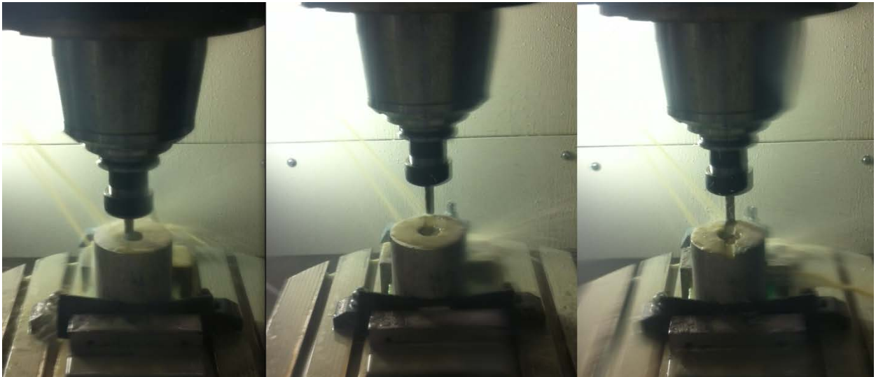
Σχήμα 3.10 Αυλάκωση κατά μήκος της διαμέτρου του δοκιμίου
