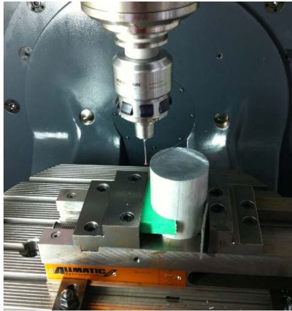
Σχήμα 3.7 Μηδενισμός με τη χρήση του οργάνου μηδενισμού
