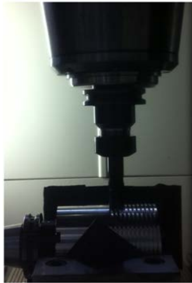
Σχήμα 3.14 Διαμήκης αυλάκωση του δοκιμίου
