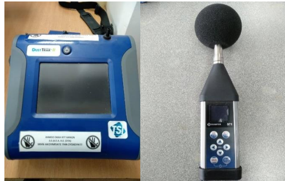
Εικόνα 3.16: Όργανο μέτρησης σωματιδίων σκόνης Dust Trak AEROSOL MONITOR 853 και όργανο μέτρησης ήχου SVANTEK 971.
