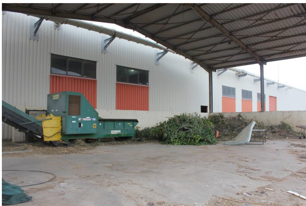
Εικόνα 3.10: Τεμαχιστής κλαδιών προς δεξαμενή κομποστοποίησης μαζί με οργανικά υλικά.
