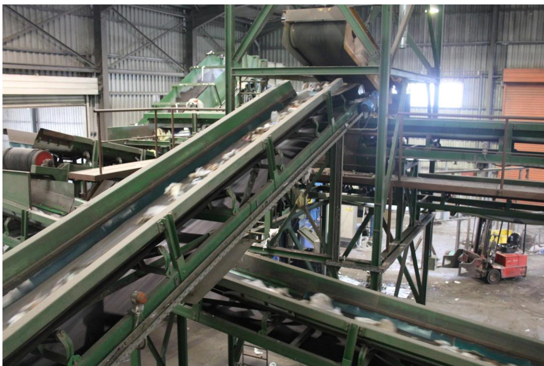
Εικόνα 3.6: Φυσικός μαγνήτης ανάκτησης σιδηρούχων υλικών
