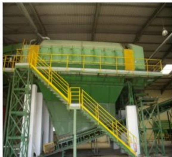
Εικόνα 3.4: Τροφοδοσία αρπάγης υλικών προς επεξεργασία και κόσκινα Μηχανικής διαλογής
