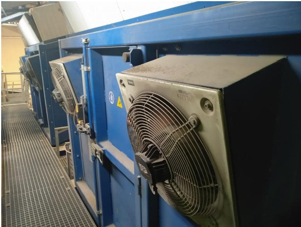
Εικόνα 3.7: Συστοιχία βαλλιστικών διαχωριστών για διαχωρισμό πλαστικών υλικών βάση σχήματος
