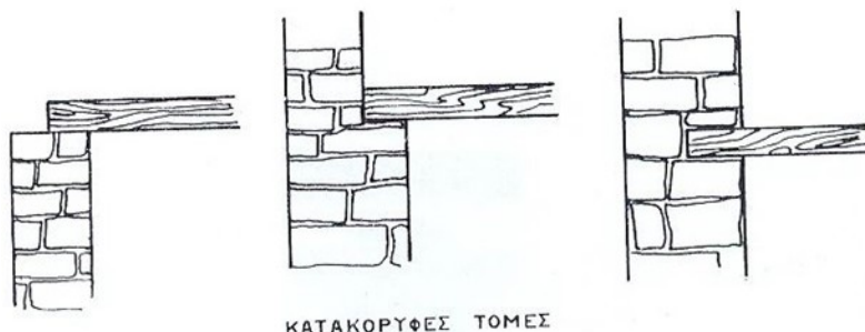
Περιπτώσεις εδράσεως ξυλοδοκών πατώματος.
