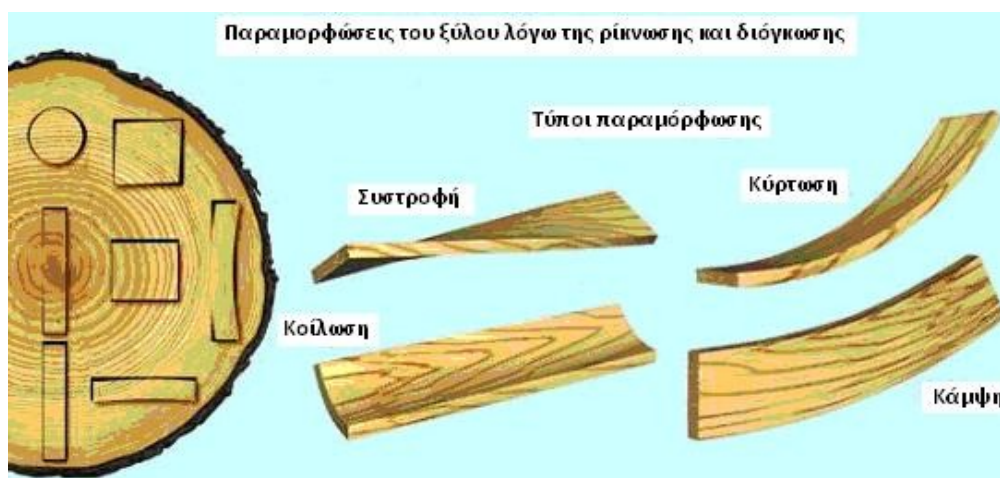
Εικόνα 3: Παραμορφώσεις του ξύλου «ΕΜΠΟΡΙΚΟ & ΒΙΟΜΗΧΑΝΙΚΟ ΕΠΙΜΕΛΗΤΗΡΙΟ ΠΕΙΡΑΙΩΣ – Τεχνίτης Ξυλουργός»
