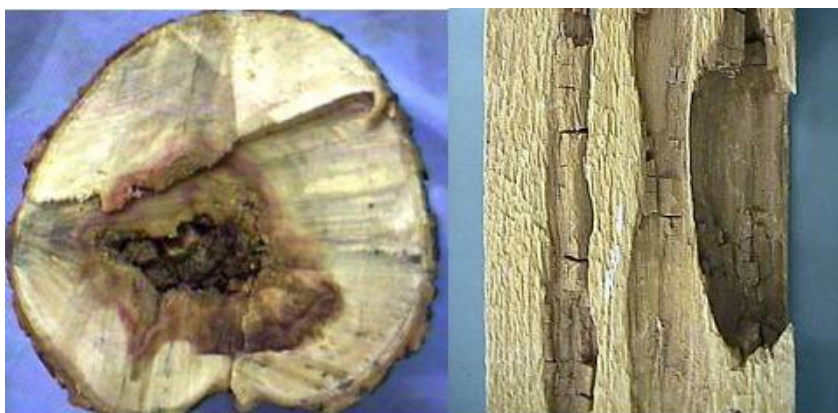
Εικόνα 4: Αλλοίωση ξύλου από μύκητες «ΕΜΠΟΡΙΚΟ & ΒΙΟΜΗΧΑΝΙΚΟ ΕΠΙΜΕΛΗΤΗΡΙΟ ΠΕΙΡΑΙΩΣ – Τεχνίτης Ξυλουργός»
