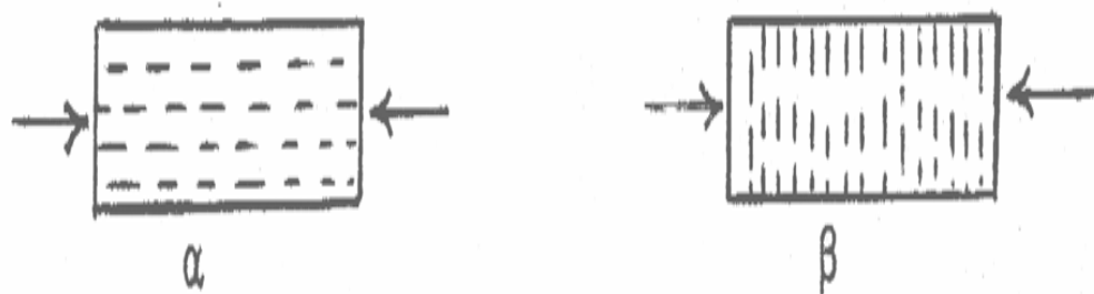
Εικόνα 7: Κατεύθυνση των δυνάμεων σε σχέση με την διεύθυνση των ινών αξονικό εφελκυσμό (α) και εγκάρσιο εφελκυσμό (β).
