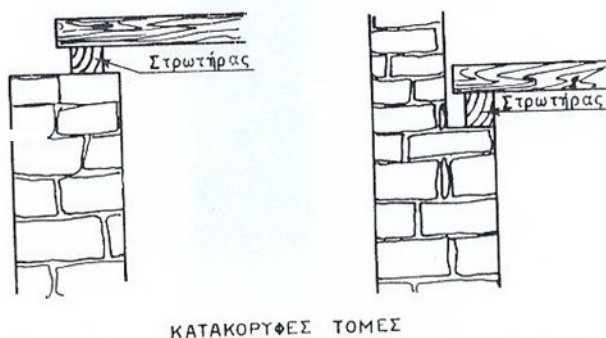
Εικόνα 24: Έδραση ξύλινων πατωμάτων
