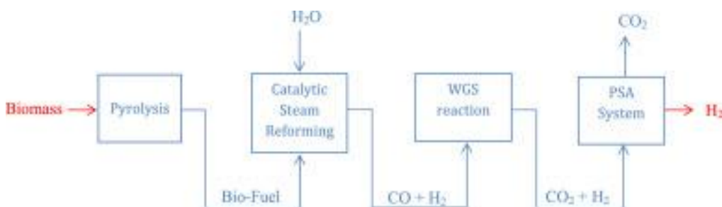
Εικόνα 1. 4:Διάγραμμα ροής πυρόλυσης της βιομάζας[9]
