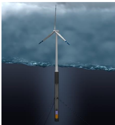
1.6: Πλατφόρμα τύπου σημαδούρας (Spar buoy) (NBC NEWS)
