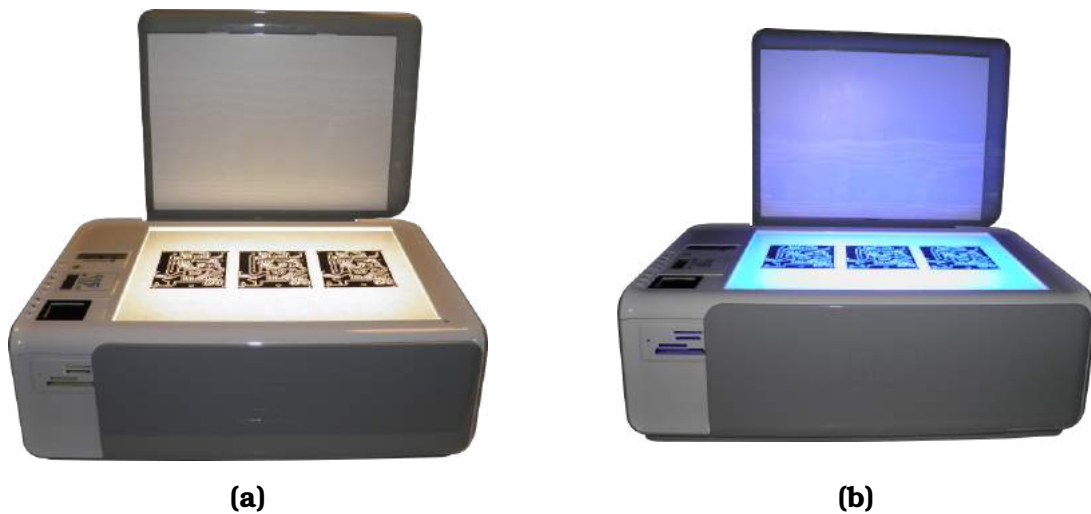
Σχήμα 50: Πρωτότυπη συσκευή δύο λειτουργιών για την εκτύπωση PCB (a) Φωτοτράπεζα (lightbox), (b) Συσκευή έκθεσης UV
