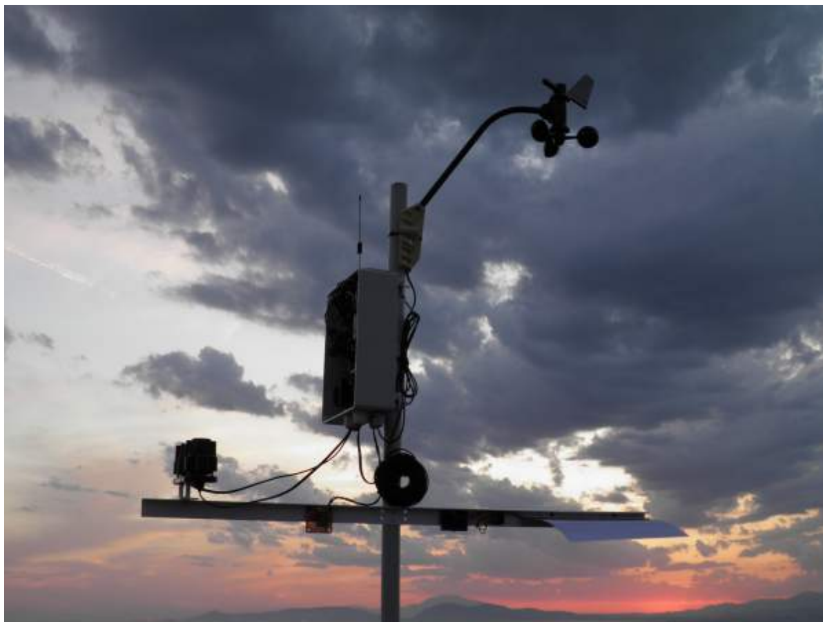
Σχήμα 72: Προτεινόμενο σύστημα CompleteSystem, προσαρτημένο πάνω σε ιστό. Διακρίνονται οι διάφοροι αισθητήρες, το κουτί των ηλεκτρονικών και ο πιεζοηλεκτρικός harvester
