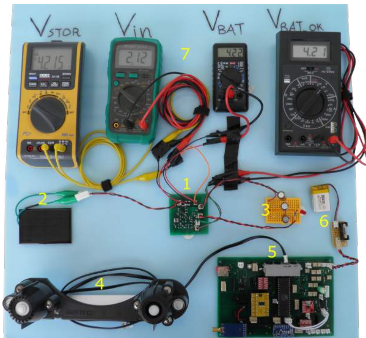
Σχήμα 68: Πειραματική διάταξη Φωτοβολταϊκού Harvester. 1. BQ25570 PCB, 2. Φωτοβολταϊκός harvester, 3. Συστοιχία πυκνωτών για αποθήκευση ενέργειας, 4. Αισθητήρας UV και ηλιακής ακτινοβολίας Davis, 5. Σύστημα CompleteSystem για καταγραφή ηλιακής ακτινοβολίας, 6. LiPo 600mAh για την τροφοδοσία του CompleteSystem, 7. Πολύμετρα για την παρακολούθηση των τάσεων της διάταξης.
