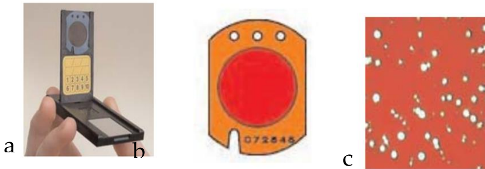
Εικόνα 3. 2: α)Ανιχνευτή ραδονίου Kodalpa, β) ταινία LR-115 και γ) Τχνη α-σωματιδίων πάνω στον LR-115 (Parajuli, 2015).
