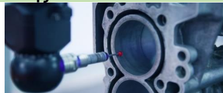
Σχήμα 2.5: Διαδικασία επιθεώρησης σημείων σε ένα εξάρτημα
