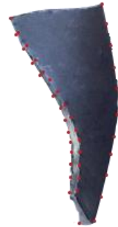
Σχήμα 2.34: Φτερό πτερωτής με εικονικά σημεία όπου συλλέχθηκαν σημεία
