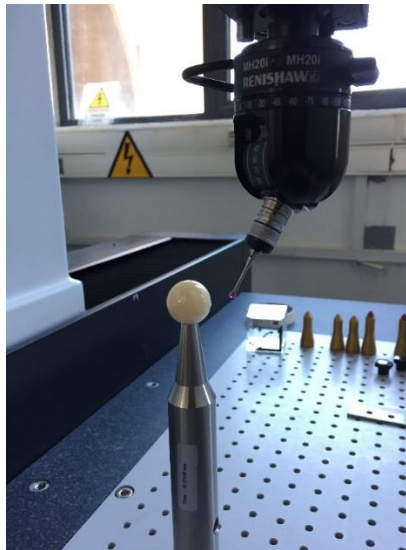
Σχήμα 3.5: Τοποθετημένη masterball στο τραπέζι εργασίας για καλυμπράρισμα ακίδας
