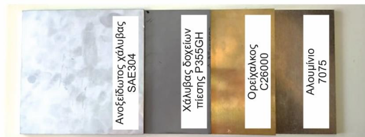
Σχήμα 3.28: Πλάκες από ανοξείδωτο χάλυβα SAE304, χάλυβα κατασκευής δοχείων πίεσης P355GH, ορείχαλκο C26000 και κράμα αλουμινίου Al7075-T6 που χρησιμοποιήθηκαν για τα πειράματα
