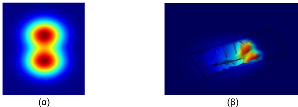
Σχήμα 2.43: (α) Hermit-Gaussian TEM 01 mode (β) Σχηματιζόμενο αυλάκι από ευθύγραμμη τροχιά παλμών δέσμης Laser
