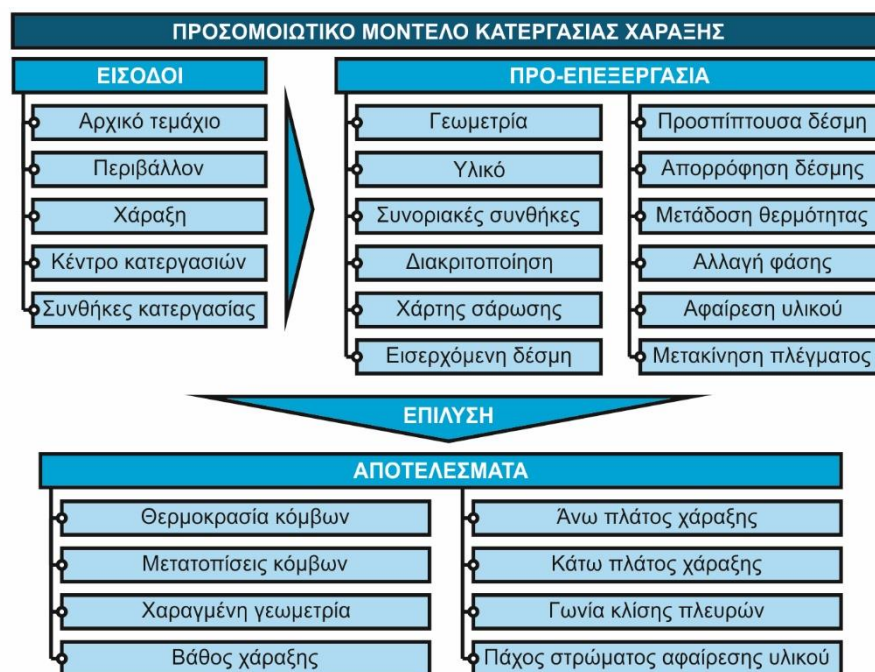
Σχήμα 3.1: Βασική δομή του μοντέλου προσομοίωσης με τη χρήση της μεθόδου των πεπερασμένων στοιχείων της κατεργασίας χάραξης με παλμούς δέσμης Laser διάρκειας νανοδευτερολέπτων
