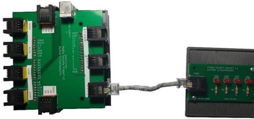
Εικόνα 3.40 Σύνδεση του φυσικού αρθρώματος 4led στην κεντρική πλακέτα
