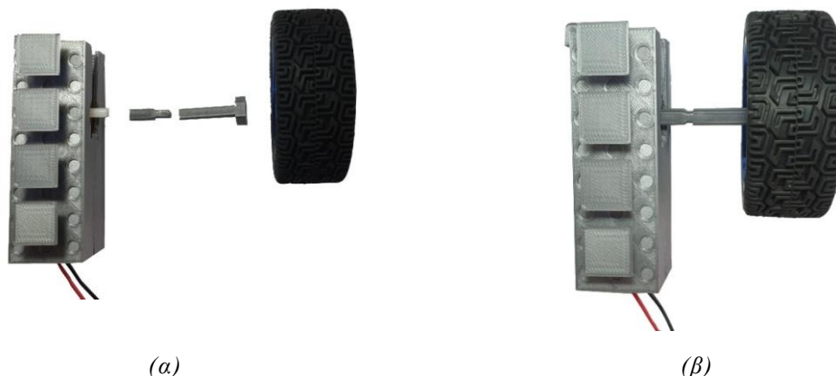
Εικόνα 5.8 (α) Αποσυναρμολογημένη όψη της σύνδεσης του κινητήρα με την ρόδα (β) Συναρμολογημένη όψη του κινητήρα με την ρόδα
