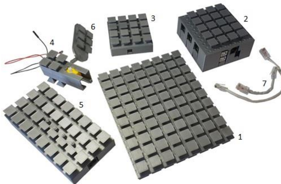
Εικόνα 5.4 Αποσυναρμολογημένη διάταξη ρομποτικού βραχίονα
