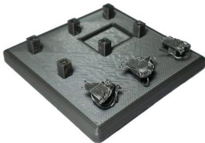
Εικόνα 4.8 Αστοχία τρισδιάστατου εκτυπωτή λόγω έλλειψης υποστηρικτικού υλικού
