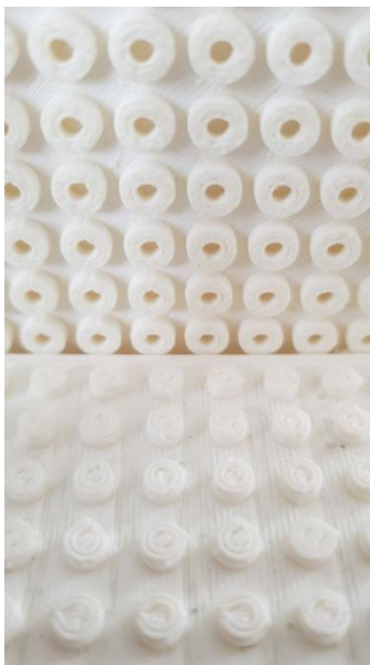
Εικόνα 4.1 Άνω και κάτω μέρος του κουμπώματος σύνδεσης τύπου Lego
