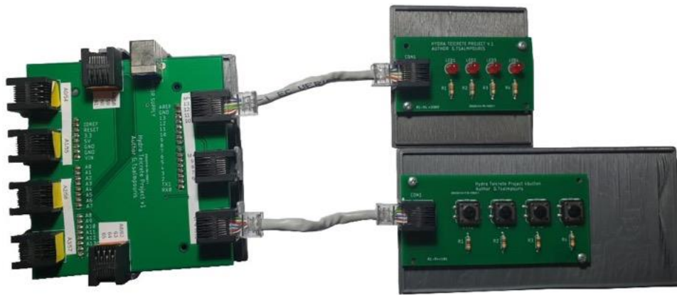
Εικόνα 3.45 Σύνδεση των φυσικών αρθρωμάτων 4led και 4button στην κεντρική πλακέτα
