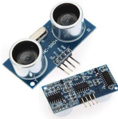
Εικόνα 3.12 Αισθητήρας υπερήχων HC-SR04 [30]
