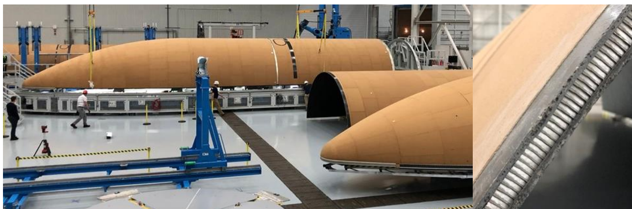
Εικόνα 56. Η χρήση των ανθρακονημάτων κατά την παραγωγή σύνθετων δομών για τον πύραυλο Atlas V στις ΗΠΑ και στην τομή η λεπτομέρεια της κατασκευής.
