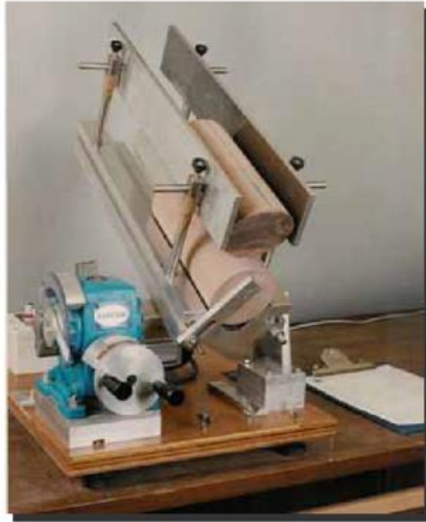
Σχήμα 9: Πειραματική διάταξη για την μέτρηση της γωνίας βασικής τριβής χρησιμοποιώντας δύο πυρήνες πετρώματος (Εξαδάκτυλος & Ξηρουδάκης, 2020).
