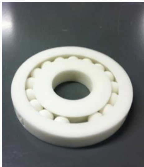
Εικόνα 2.1 Ένα τυπωμένο ρουλεμάν που κατασκευάστηκε ως συναρμολογημένο στην εταιρεία America Makes με τη χρήση της τεχνολογίας SLS. Η κατασκευή του με τη χρήση συμβατικών διεργασιών θα απαιτούσε τη δημιουργία 18 διαφορετικών κομματιών και τη μεταξύ τους συναρμολόγηση (Conner et al., 2014).
