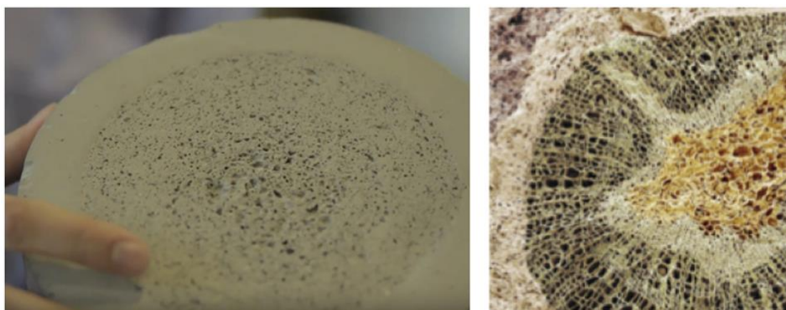
Εικόνα 2.8 Σκυρόδεμα μεταβλητής πυκνότητας που κατασκευάστηκε μέσω FGAM, μιμούμενο την ακτινικά διαβαθμισμένη πυκνότητα ενός φοινικόδεντρου (Loh et al., 2018)
