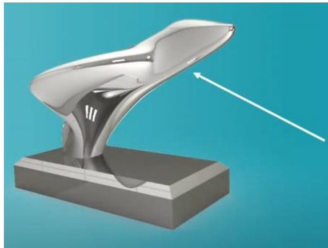
Εικόνα 1.5 Μεγάλη προεξοχή που χρειάζεται στηρίγματα (πηγή: Siemens)
