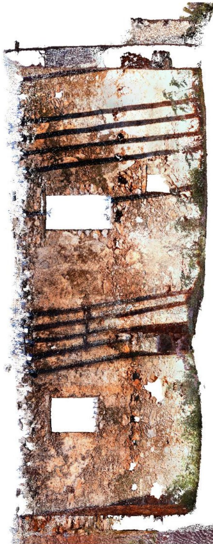
Εικόνα 42: Τομή στον άξονα Δύση – Ανατολή στη θέση του τοιχισμένου παραθύρου / αποδιοργάνωση λίθων εσωτερικά της ανατολικής λιθοδομής - αποτύπωση εσωτερικού βόρειας λιθοδομής.
