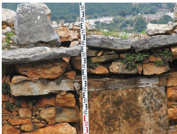
Εικόνα 28: Μέτρηση υψομετρικής διαφοράς με τη χρήση σταδίας.
