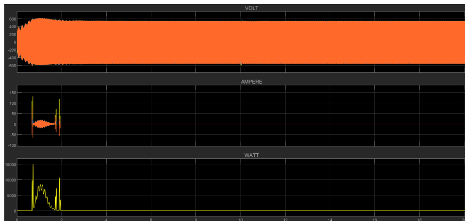
Εικόνα 7.118: Μεταφορά ισχύος μέσω του ανορθωτή του σεναρίου B2.
