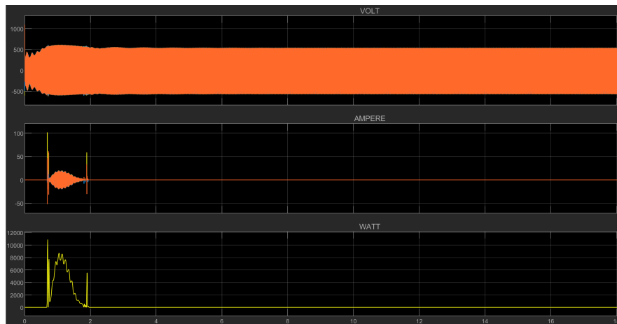
Εικόνα 7.79: Μεταφερόμενη ισχύς μέσω του ανορθωτή του σεναρίου A7.
