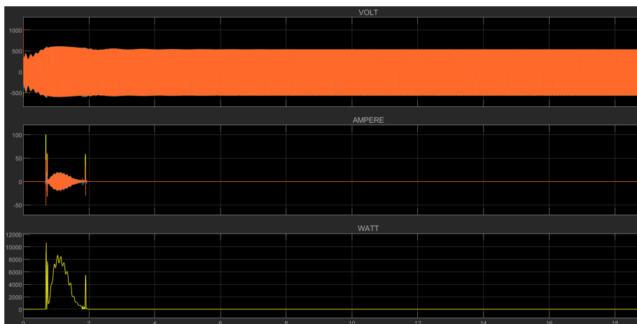
Εικόνα 7.90: Παραδιδόμενη ισχύς από τον ανορθωτή του σεναρίου A8.
