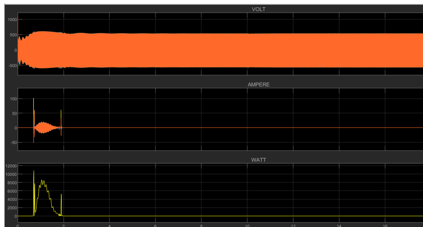
Εικόνα 7.24: Μεταφερόμενη ισχύς μέσω του rectifier του σεναρίου A2.
