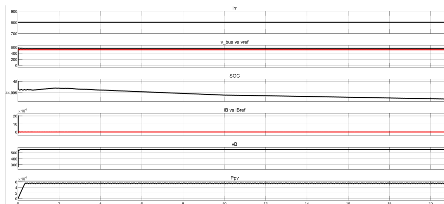
Εικόνα 7.21: Κατάσταση φόρτισης της μπαταρίας του σεναρίου A2. Κατά την στιγμή της μεταβολής, παρατηρείται ότι η μπαταρία συνεχίζει να εκφορτίζεται, όμως ο ρυθμός εκφόρτισης της είναι αισθητά μειωμένος. Ουσιαστικά, πάλι τροφοδοτεί το σύστημα με ενέργεια αλλά αισθητά μικρότερη σε μέγεθος (φαίνεται από την αλλαγή της κλίσης του SoC (Εικόνα 7.21)).
