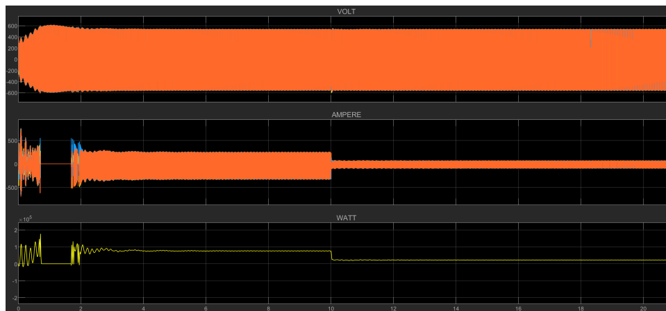
Εικόνα 7.116: Μεταφορά ισχύος μέσω του αντιστροφέα του σεναρίου B2.
