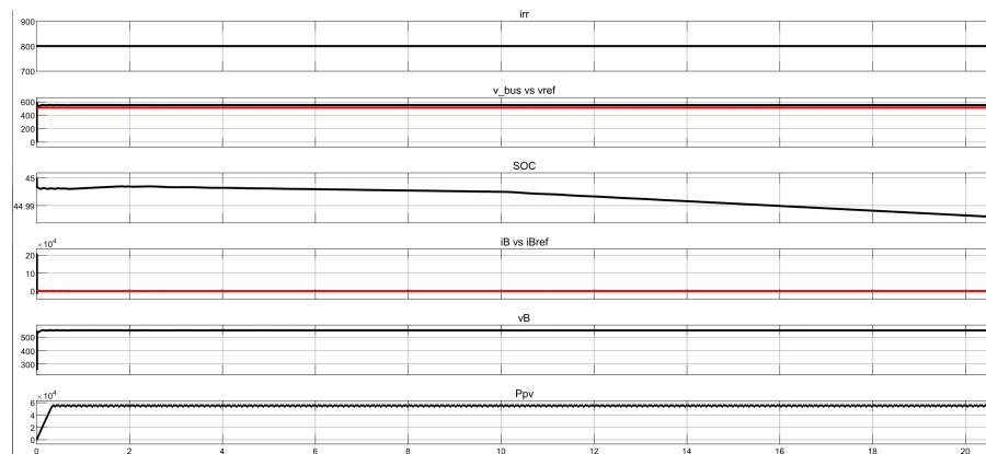
Εικόνα 7.7: Αποδιδόμενη ισχύς των φωτοβολταϊκών πάνελ και το SoC της μπαταρίας.
