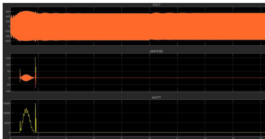
Εικόνα 7.104: Μεταφορά ισχύος μέσω του ανορθωτή του σεναρίου B1.
