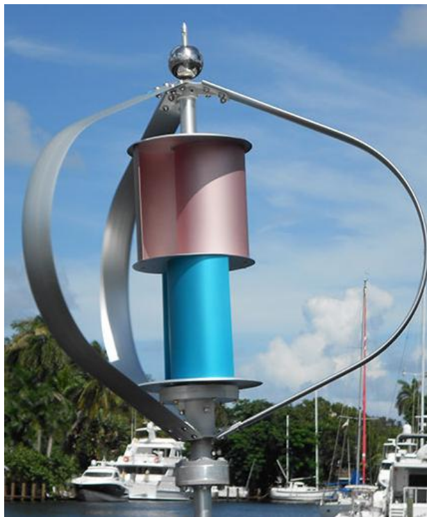
Εικόνα 1.7: Ανεμογεννήτρια μεικτού τύπου, Darrieus και Savonius
