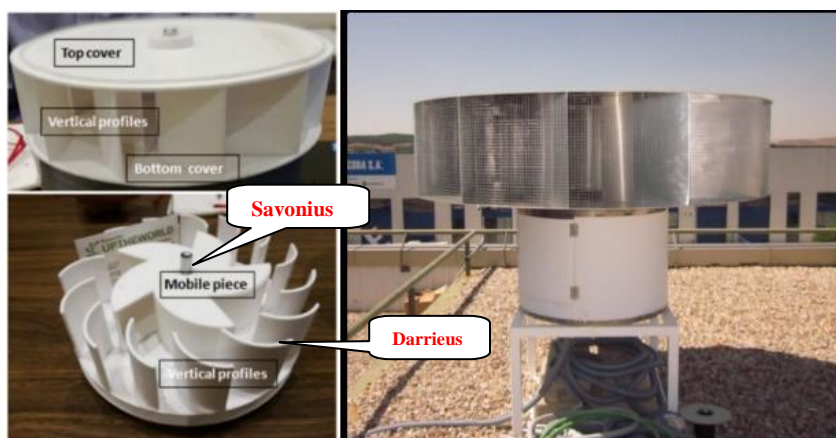
Εικόνα 1.8: Ανεμογεννήτρια της Eoli FPS, πρωτότυπο(αριστερά) και σε πραγματικές διαστάσεις(δεξιά)
