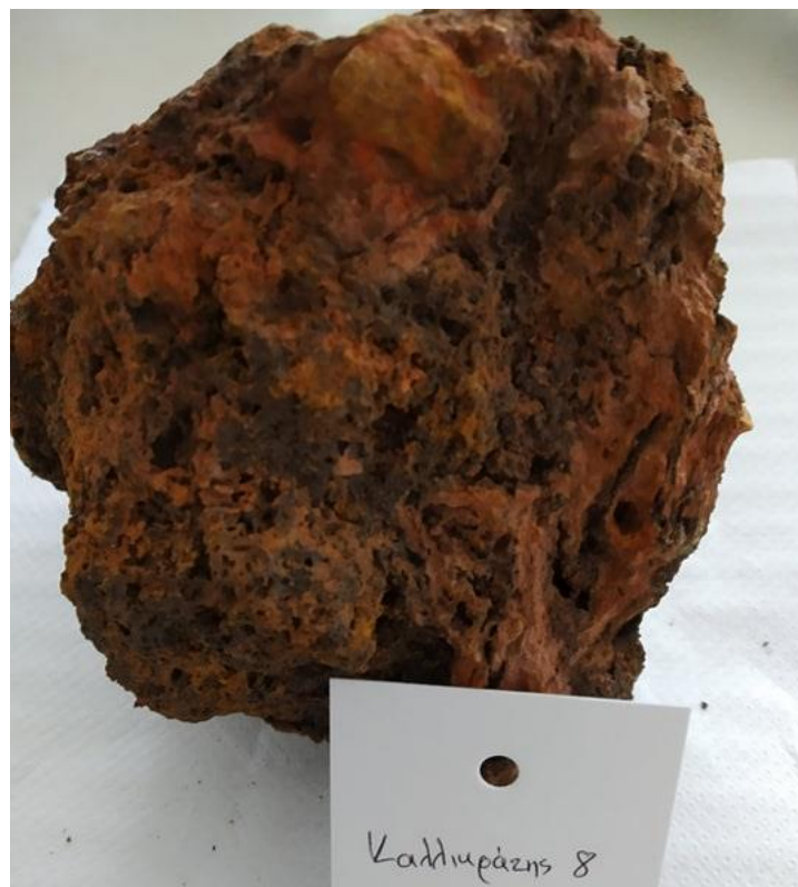
Εικόνα 4-1: Δείγμα “Καλλιμράνης” νο.8 πριν εισέλθει στο σιαγονωτό σπαστήρα
