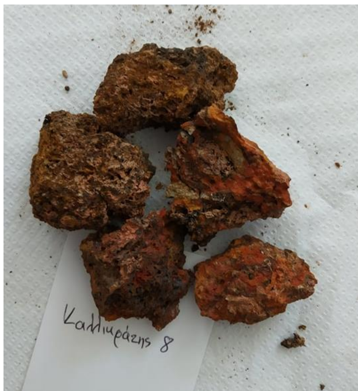
Εικόνα 4-2: Δείγμα “Καλλιμάρας” νο.8 μετά την είσοδό του στο σιαγονωτό σπαστήρα (μέγιστο δυνατό άνοιγμα)
