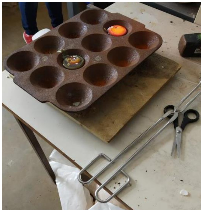
Εικόνα 4-3: Χύτευση δειγμάτων σε μεταλλικά κωνικά καλούπια
