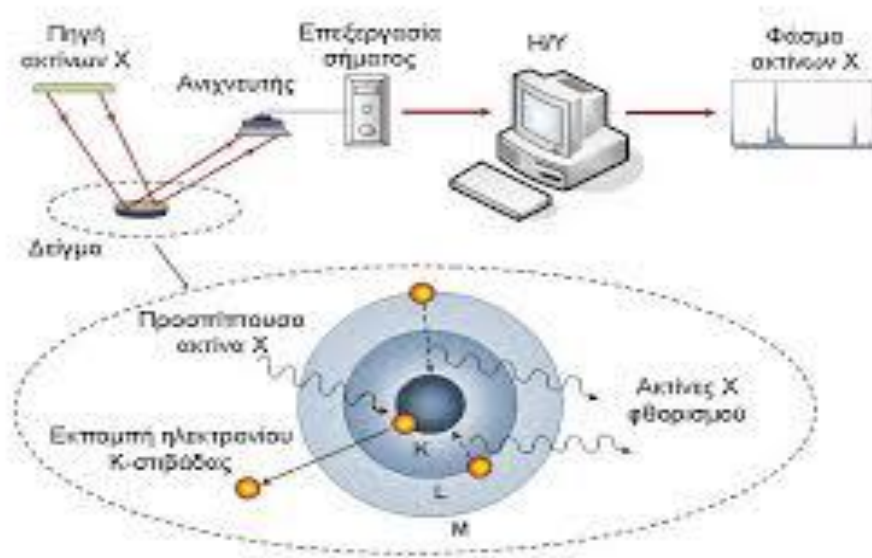
Σχήμα 4.1: Η αρχή λειτουργίας και η τυπική διάταξη φασματοσκοπίας XRF
