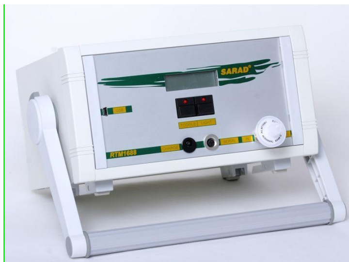
Εικόνα 2.1. Το όργανο SARAD RTM 1688-2 που χρησιμοποιήθηκε για τις μετρήσεις ραδονίου.
