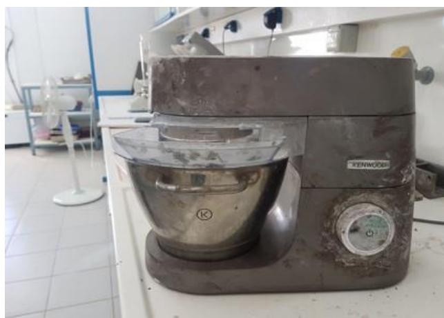
Σχήμα 4.2: Συσκευή σύνθεσης (μίξερ) ανόργανων πολυμερών μετακαολίνη.
