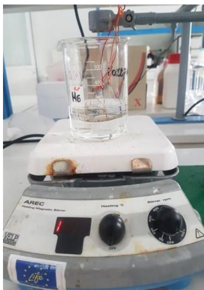
Σχήμα 4.5: Διεξαγωγή πειραμάτων απομάκρυνσης, Sc από υδατικά διαλύματα με εναιώρηση δισκίων ανόργανων πολυμερών μετακαολίνη.
