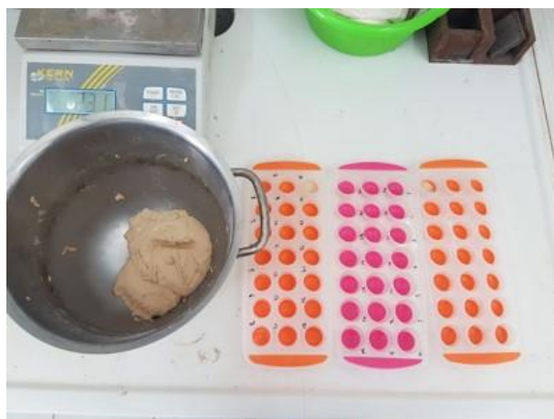
Σχήμα 4.3: Πάστα ανόργανου πολυμερούς μετακαολίνη και οι μήτρες όπου τοποθετείται η πάστα ώστε να παραχθούν δισκία ανόργανων πολυμερών μετακαολίνη.
