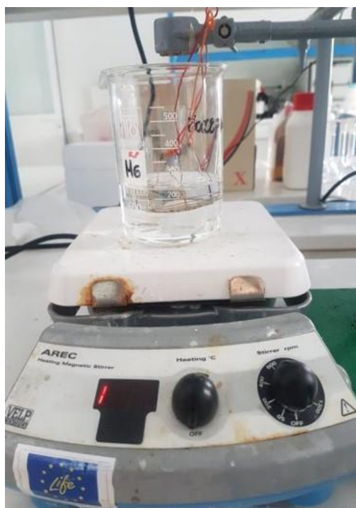
Σχήμα 4.4: Διεξαγωγή πειραμάτων απομάκρυνσης Nd, από υδατικά διαλύματα με εναιώρηση δισκίων ανόργανων πολυμερών μετακαολίνη.
