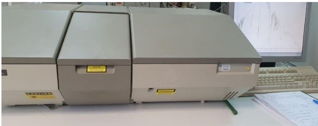
Σχήμα 3.1: Perkin Elmer FTIR- Spectrometer SPECTRUM 1000 στο Εργαστήριο Ανάλυσης Ρευστών και Πυρήνων Υπογείων Ταμιευτήρων, Σχολή ΜΗΧΟΠ, Πολυτεχνείο Κρήτης.
