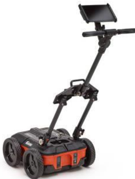
Εικόνα 4. Συσκευή Γεωραντάρ της εταιρείας JCG. Η συσκευή είναι η UtilityScan με ενσωματωμένο σύστημα LineTrac. Διαθέτει κεραία 350 MHz και ανιχνεύει στόχους σε βάθος έως 10 m. 6
