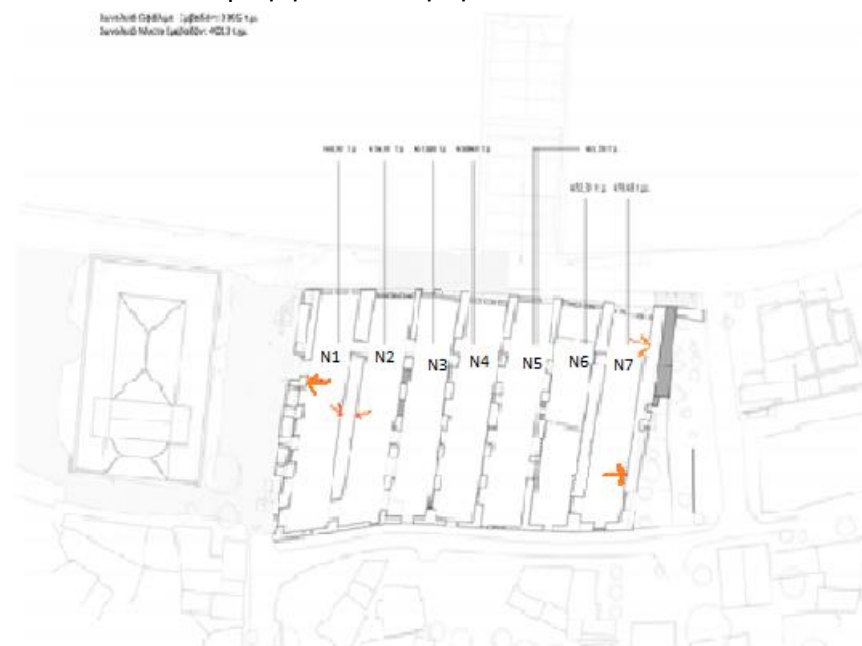
Εικόνα 18. Κάτοψη Νεωρίων με κόκκινα βέλη οι θέσεις σε τοίχους στα Νεώρια Χανίων στις οποίες πραγματοποιήθηκε η γεωφυσική διασκόπηση
