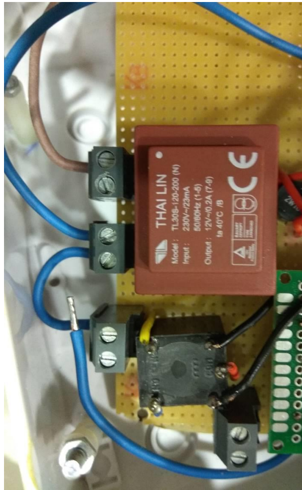
Σχήμα 3-5 Θέση ηλεκτρονόμου και μετασχηματιστή στην κεντρική πλακέτα του ασύρματου κόμβου.
