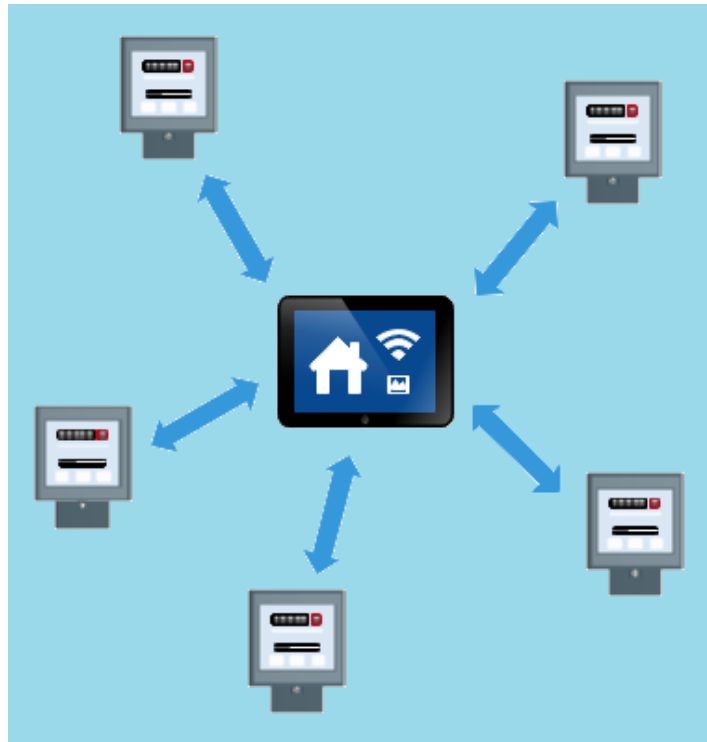
Σχήμα 2-1 Δίκτυο ασύρματων αισθητήρων σε τοπολογία αστέρα.
