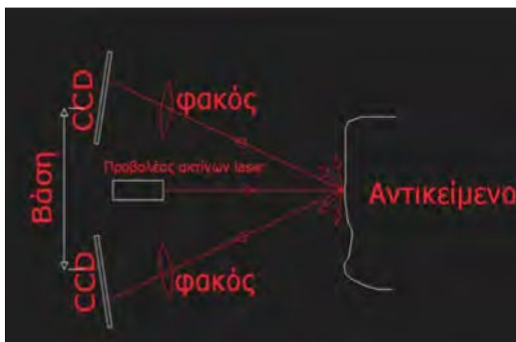
Σχήμα 1. 8: Μέθοδος Τριγωνισμού Με 2 CCD Συστοιχίες
