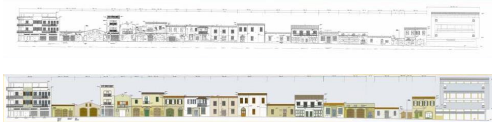
Εικόνα 42: Αποκατάσταση και συντήρηση όψεων οικοδομών
