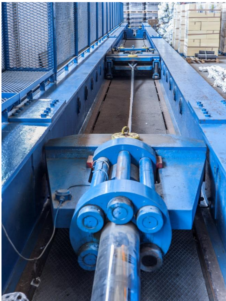
Εικόνα 2-18 Μηχανή εφελκυσμού του τελικού προϊόντος
