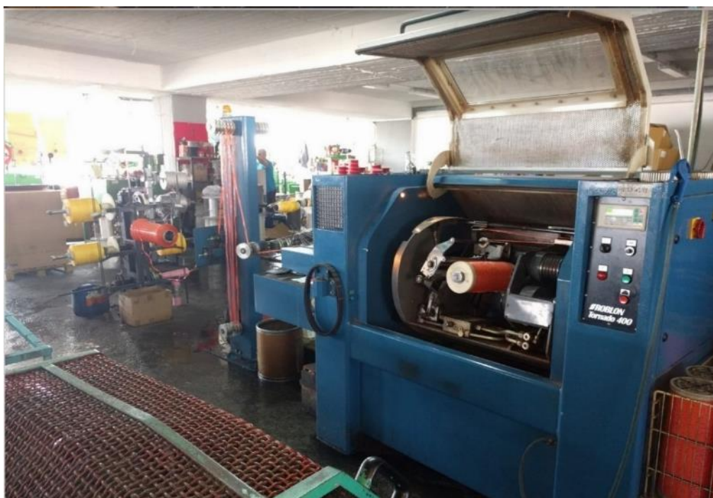
Εικόνα 2-8 Στρεπτική μηχανή – (από τα αριστερά της εικόνας) φαίνεται ο σιδερένιος σωλήνας με το νήμα το οποίο αρχίζει και δέχεται στρέψη μέχρι που τυλίγεται ως στριμμένο νήμα σε χάρτινο σωλήνα (στα δεξιά της εικόνας)
