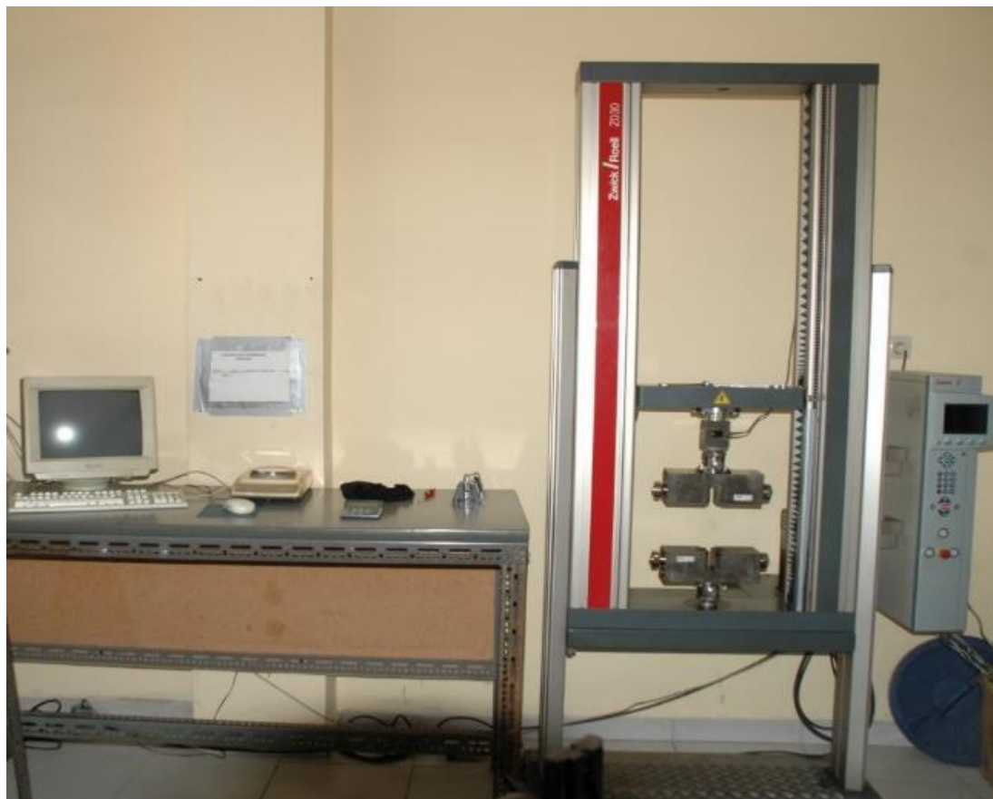
Εικόνα 2-17 Μηχανή εφελκυσμού ίνας, νήματος και στριμμένου νήματος
