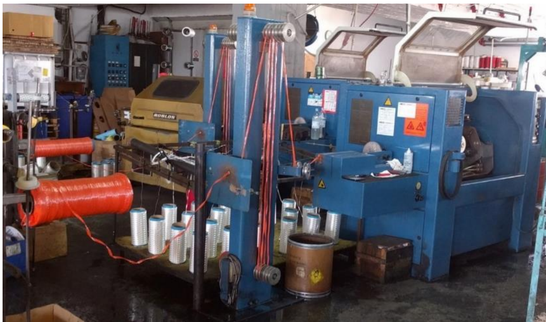
Εικόνα 2-7 Στρεπτική μηχανή – (από τα αριστερά της εικόνας) φαίνεται ο σιδερένιος σωλήνας με το νήμα το οποίο αρχίζει και δέχεται στρέψη μέχρι που τυλίγεται ως στριμμένο νήμα σε χάρτινο σωλήνα (στα δεξιά της εικόνας και στην επόμενη εικόνα)
