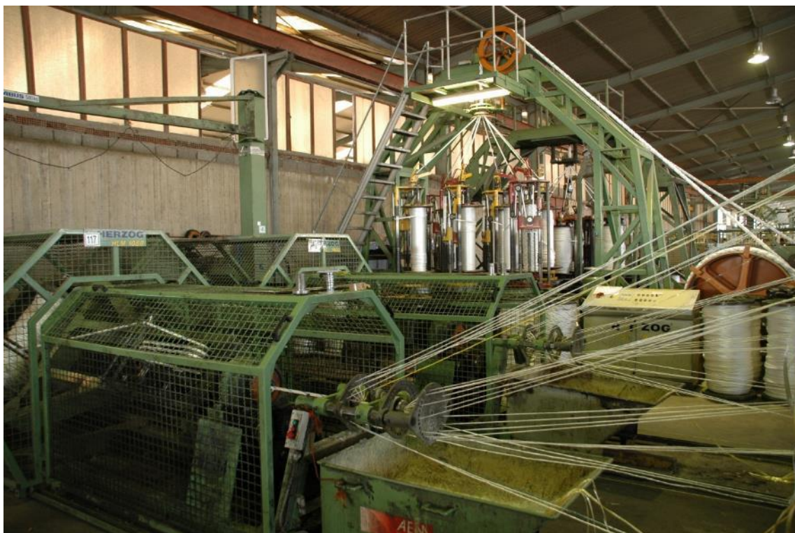
Εικόνα 2-10 Εμβολομηχανές – δημιουργία τελικού κλώνου ή εμβόλου
