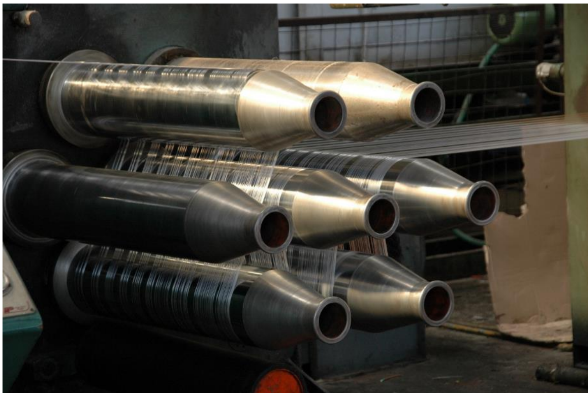
Εικόνα 2-6 Μηχανή εξώθησης - οι ίνες περνάνε από τα ράουλα
