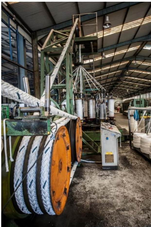
Εικόνα 2-13 Πλεκτική μηχανή – το πλεγμένο σχοινί τανύζεται πριν πάει να τυλιχτεί στον τελικό κάβο
