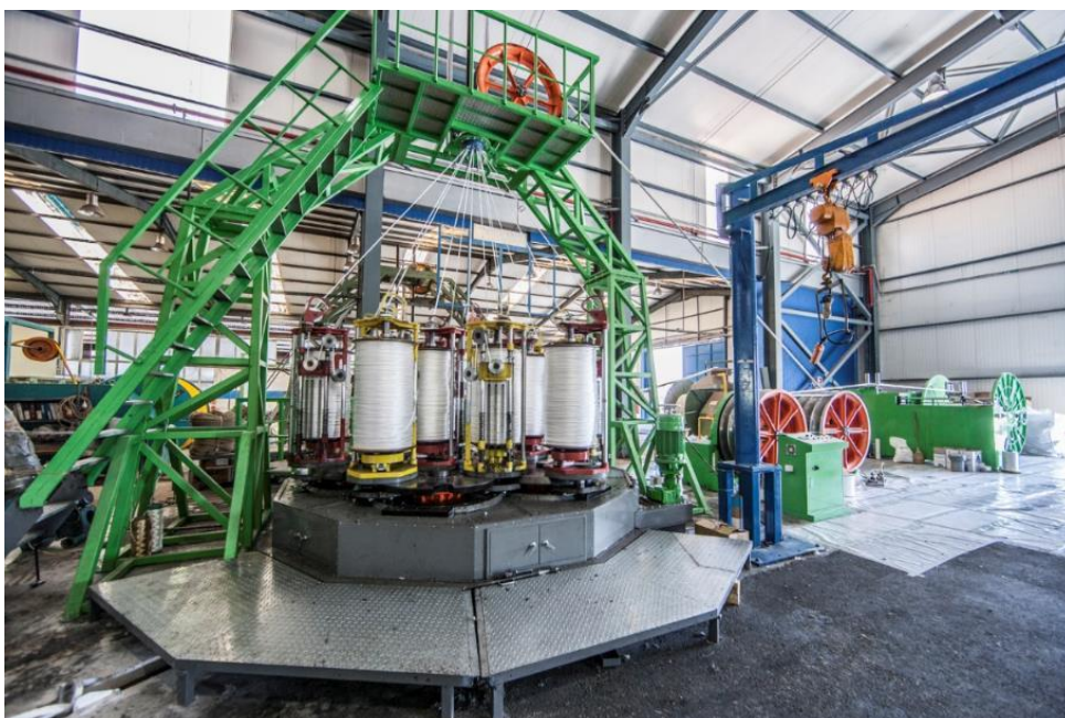
Εικόνα 2-12 Πλεκτική μηχανή – (από αριστερά) οι κλώνοι τοποθετημένοι στα μεγάλα σιδερένια καρούλια για την τελική πλέξη του σχοινιού
