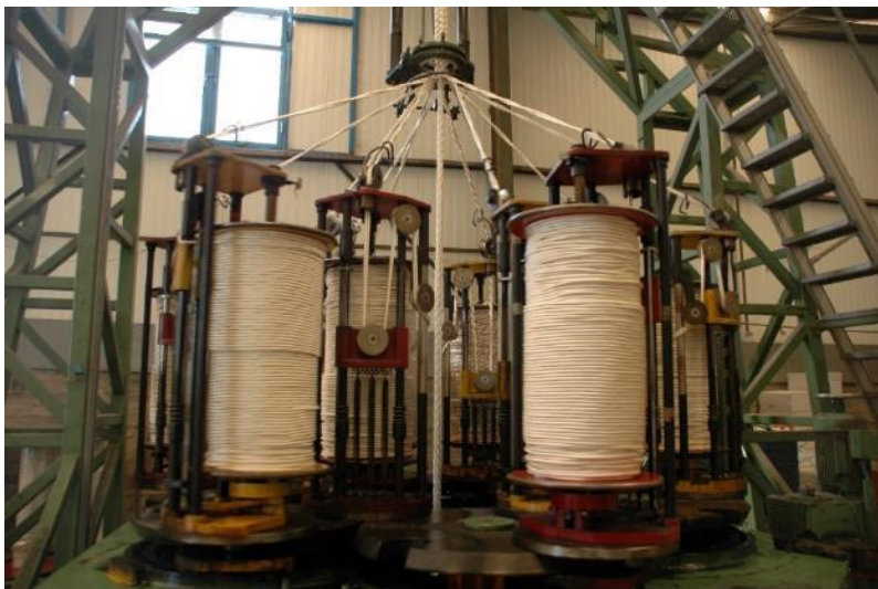
Εικόνα 2-11 Πλεκτική μηχανή – οι κλώνοι τοποθετημένοι στα μεγάλα σιδερένια καρούλια για την τελική πλέξη του σχοινιού
