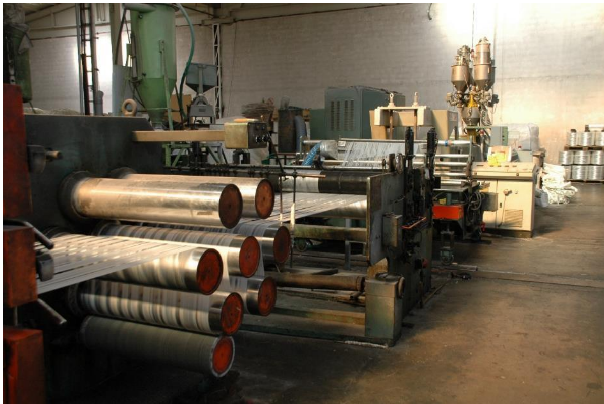
Εικόνα 2-5 Μηχανή εξώθησης – Στο βάθος απεικονίζεται η μηχανή που θερμαίνει και λιώνει την πρώτη ύλη (κόκκοι) που στη συνέχεια ψύχεται και κόβεται σε ίνες οι οποίες περνάνε από τα ράουλα και τέλος τυλίγονται σε σιδερένιους σωλήνες
