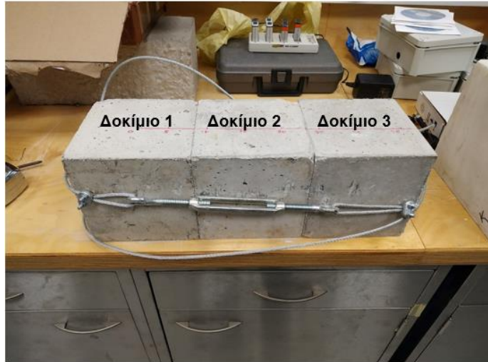
Εικόνα 24 : Περίδεση δοκιμίων σκυροδέματος για διεξαγωγή πειράματος
