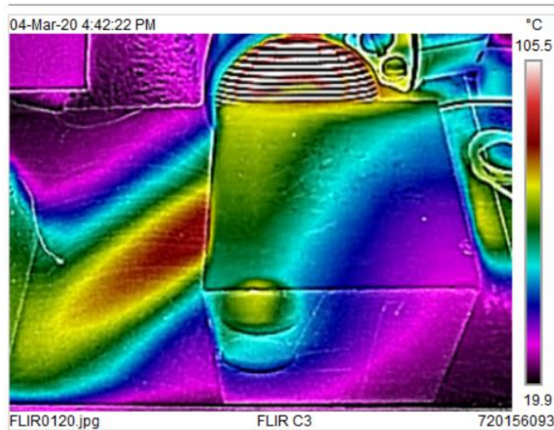
Εικόνα 42: Αυξημένη θερμοκρασία στην περιοχή της οπής μετά την 1 ώρα θέρμανσης
