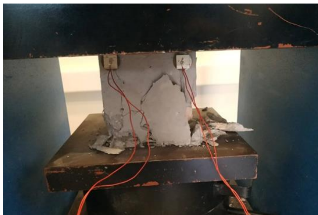
Εικόνα 72: Δοκίμιο μετά τη θραύση του
