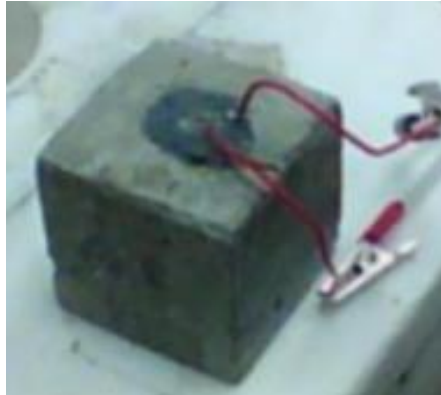
Εικόνα 46: Πιεζοηλεκτρικός διεγέρτης
