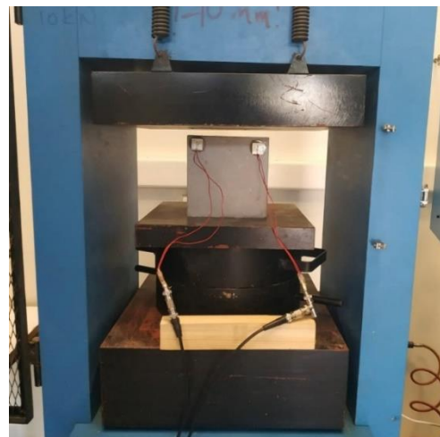
Εικόνα 55: Δοκίμιο σε διαδικασία θλίψης
