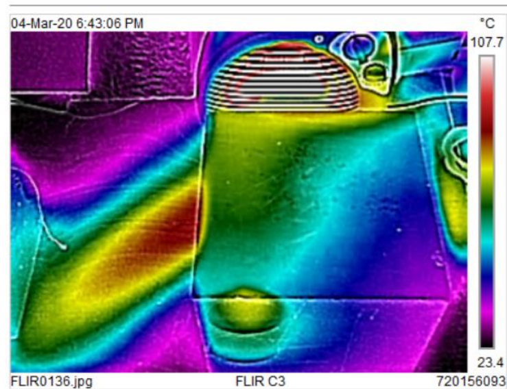
Εικόνα 44: Αυξημένη θερμοκρασία στην περιοχή της οπής μετά τις 3 ώρες θέρμανσης
