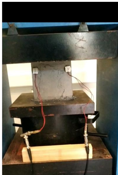
Εικόνα 60: Δοκίμιο μετά τη θραύση του
