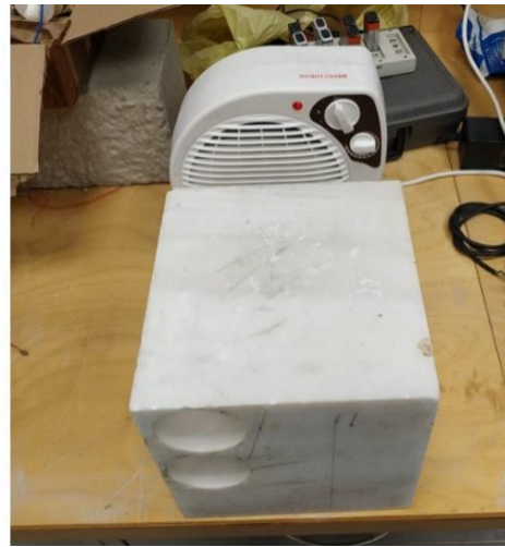
Εικόνα 40: Δοκίμιο υπό θέρμανση
