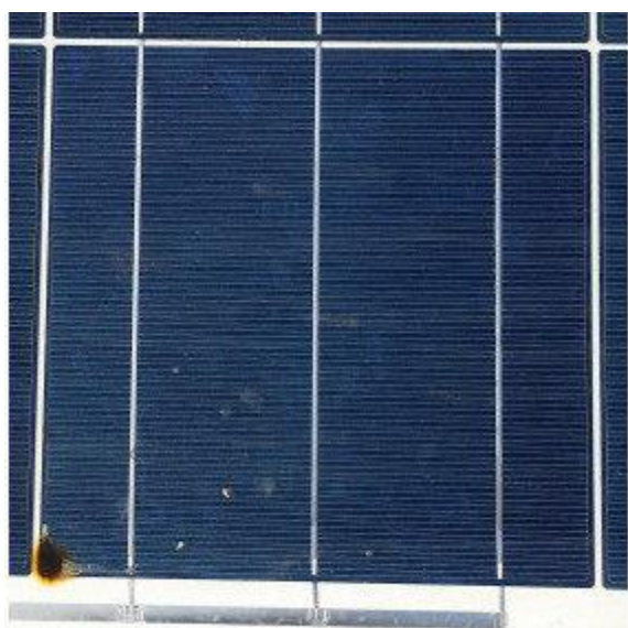
Εικόνα 72. Παραδείγματα φαινομένου hot spot σε κελί κρυσταλλικού πυριτίου [61]
