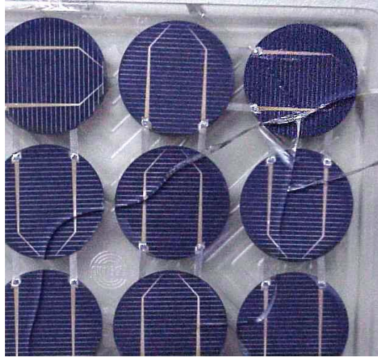
Εικόνα 73. Ραγισμένο κελί εξαιτίας αυξημένης θερμοκρασίας σε σκιασμένο κελί [62]
