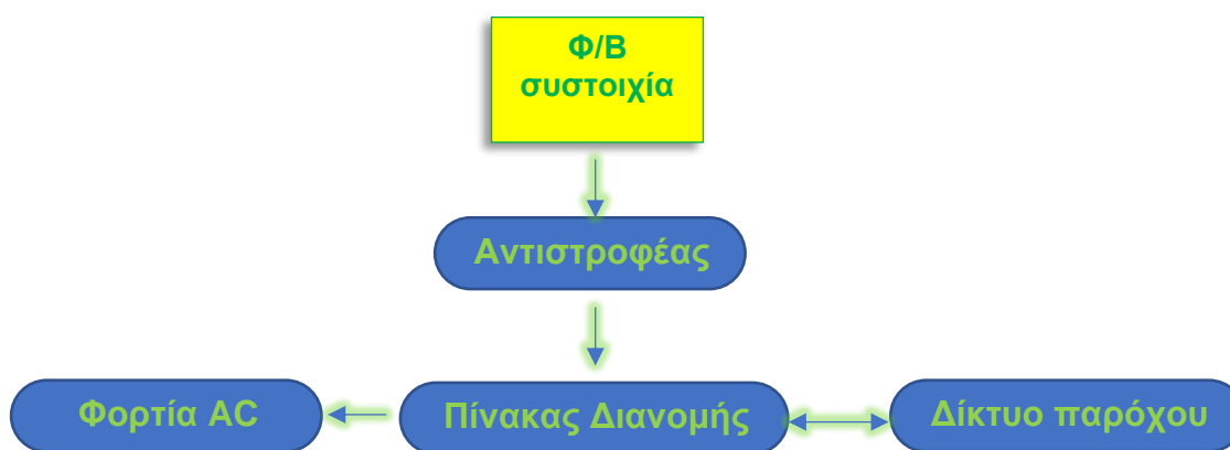
Εικόνα 50. Διάγραμμα Φ/Β συστήματος ιδιοκατανάλωσης (on grid)
