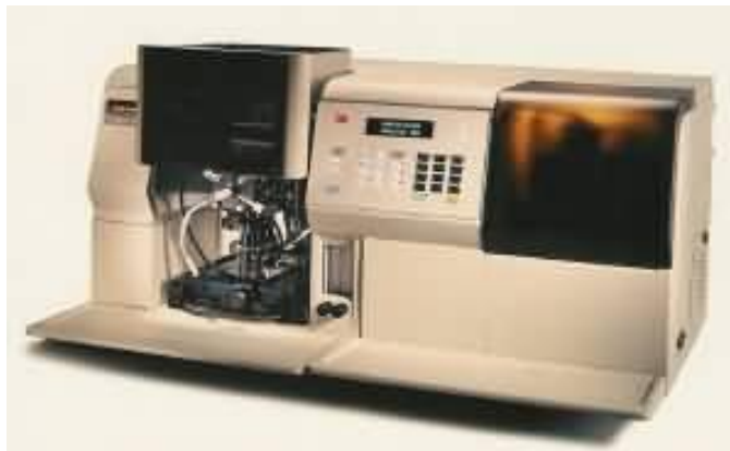
Σχήμα 3.6: Φασματόμετρο AAnalyst 100 της εταιρίας Perkin Elmer
