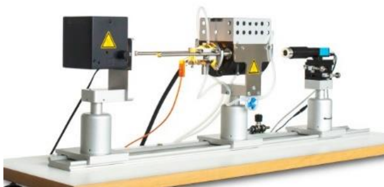
Σχήμα 3.9: Θερμαινόμενο μικροσκόπιο οριζόντιου άξονα
