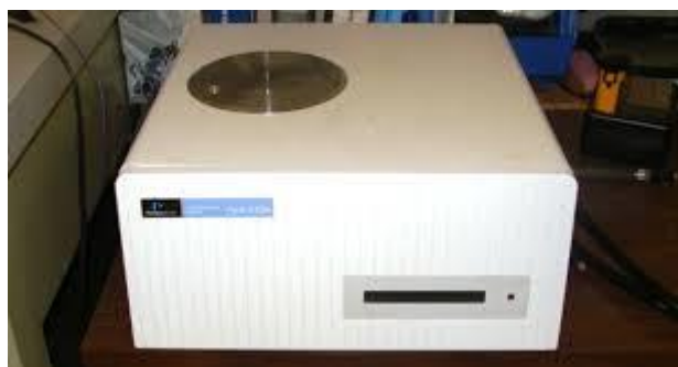
Σχήμα 3.1: Θερμοζυγός τύπου TGA 6 της εταιρίας Perkin Elmer
